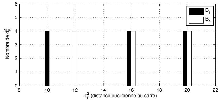
FIGURE 4.12 – Spectres des distances des blocs du code de Rassool et al. 4 états 4-PSK 6 antennes d’émission
