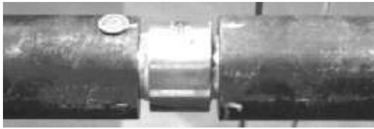
FIG. 3.14 – Échantillon de béton confiné mis en place entre les barres
