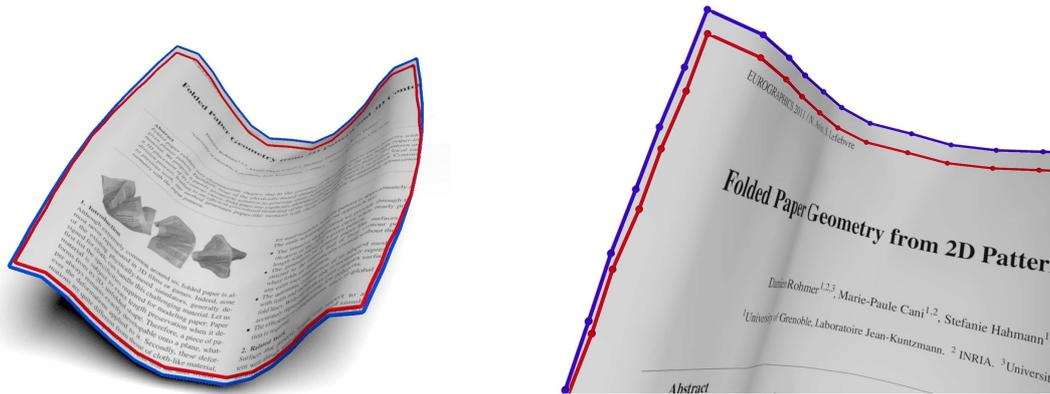
**FIGURE 4.26** – Déformation du bord 3D de la surface lors de l'étape de relaxation globale. Le bord initial donné en paramètre est indiqué en rouge, alors que le bord final après convergence est donné par la courbe bleue.
