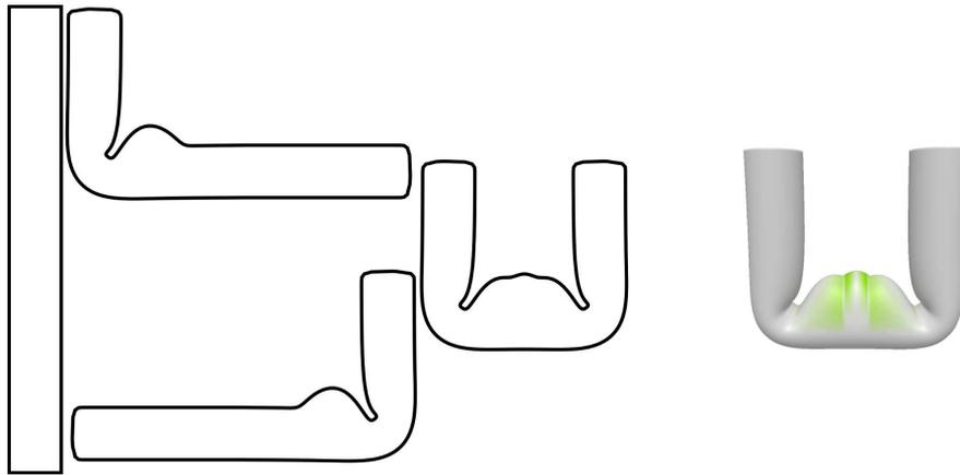
**FIGURE 2.35** – *Dépendance de l'ordre de parcours du squelette d'animation. Le tube de gauche représente le cylindre original. Les tubes centraux représentent le premier os articulé dans les deux cas de l'analyse. Le profil résultant après avoir plié les deux articulations est montré à droite. La distribution de la différence entre les deux surfaces est encodée en couleur verte sur l'image de droite.*
