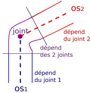
**FIGURE 2.17** – Définition automatique des régions nécessitant une compensation de volume. Les régions subissant des pertes de volumes liées à la méthode du skinning sont celles situées autour des articulations, car elles sont liées à plusieurs os.
