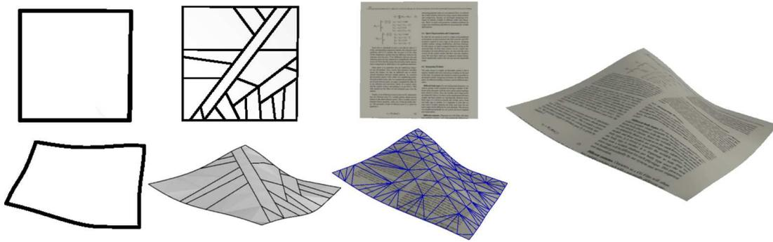
**FIGURE 4.15** – Exemple de reconstruction de surface tendue. De gauche à droite : Courbes initiales (patron 2D et 3D) ; découpage des régions obtenues le long des droites lancées récursivement ; domaine texturé et maillage de la surface 3D ; résultat final.
