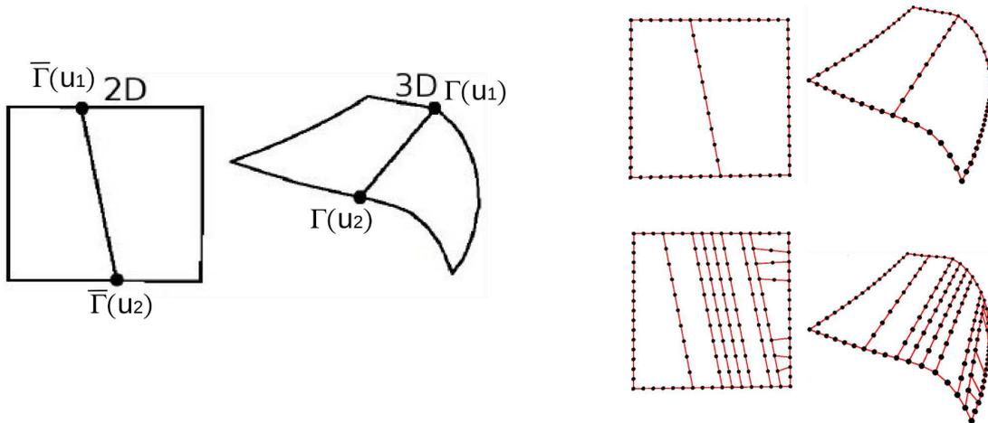
**FIGURE 4.8** – Tracé de segments tendus entre deux positions du bord. la figure de gauche illustre le cas de la correspondance entre le segment sur le patron et la partie 3D. La figure de droite illustre le cas discret suivant un nombre fini de sommets, ainsi que la poursuite de l’algorithme sur ce cas.
