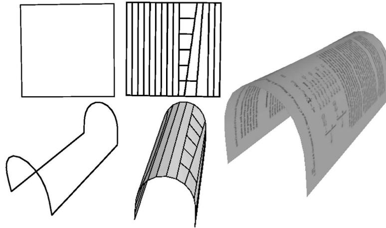
**FIGURE 4.17** – *Reconstruction de surface tendue dans le cas d'une déformation 3D importante.*
