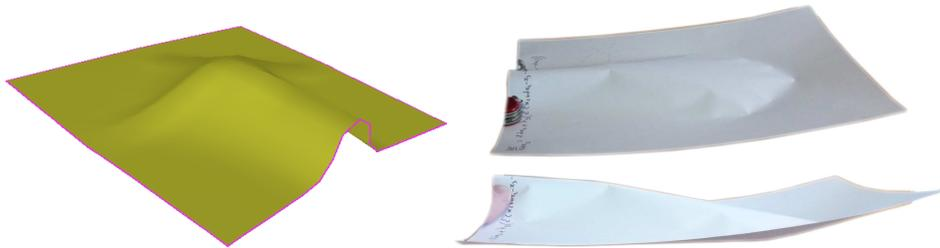
**FIGURE 4.19** – Gauche : Surface obtenue par un modèle masse-ressort de tissu interpolant les mêmes bords que pour notre entrée avec une contrainte de non-pénétration sphérique interne. Droite : Photos d'une vraie feuille de papier pliée sous deux angles différents. Nous remarquons combien le modèle masse-ressorts est une mauvaise approximation du papier.
