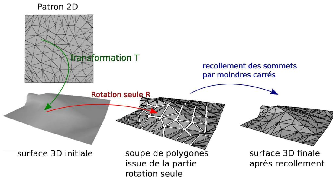
**FIGURE 4.12** – *Algorithme de déformation par préservation de rigidité. Les matrices de transformation du patron vers la surface 3D sont exprimées. En ne gardant que la partie rotationnelle des matrices de déformations, nous obtenons une soupe de polygones. Enfin, les sommets sont recollés afin de former un maillage connexe à l'aide d'une minimisation par moindres carrés.*
