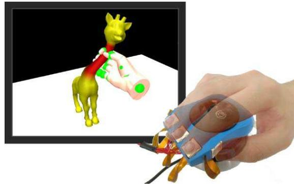
FIGURE 2.39 – Dispositif du Hand-Navigator développé par Chardonnet *et al.* utilisé pour la déformation d'un objet virtuel. Image issue de [CAL<sup>+</sup>10].
