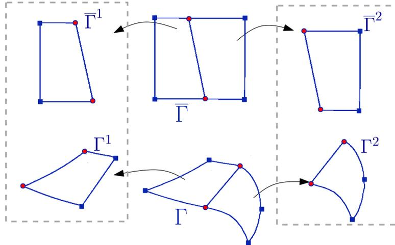
**FIGURE 4.6** – Étapes de subdivision récursives : le patron 2D et le contour 3D correspondant (milieu) sont subdivisés en deux parties (gauche et droite) le long d’une ligne de pli qui est représentée par un segment dans l’espace du patron.
