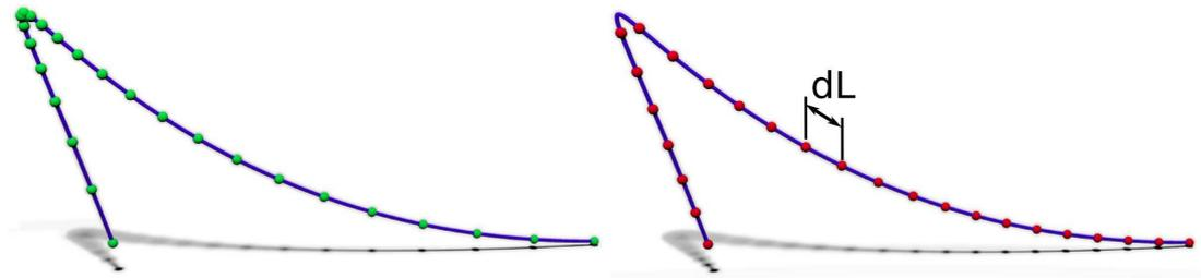
**FIGURE D.1** – Échantillonnage d'une courbe cubique. La courbe de gauche correspond à un échantillonnage uniforme dans l'espace des paramètres de la cubique alors que la figure de droite est échantillonnée régulièrement suivant la distance curviligne. Dans le cas d'une correspondance avec un segment de droite isométrique à la cubique, les sommets seront régulièrement espacés sur le segment également.
