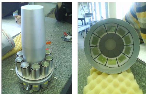
FIGURE 2.9 – A gauche, on peut voir les PM qui entourent le capot interne d'une enceinte BGO. A droite, on distingue les 10 cristaux de BGO à l'intérieur de l'enceinte anti-Compton.
