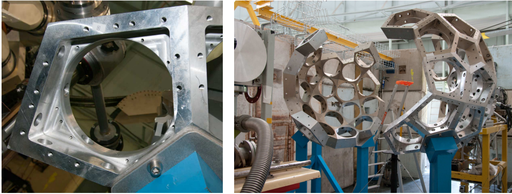
FIGURE 2.17 – A gauche, une alvéole composant la structure de la sphère ORGAM. A droite, le support d'ORGAM avant l'installation des détecteurs.
