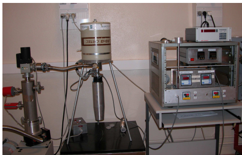
FIGURE 2.3 – Le banc de pompage du Labo Germanium. La pompe se situe sur la gauche de l'image. À droite, on voit le régulateur de température.
