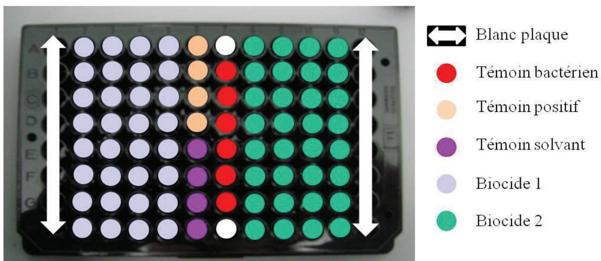
Figure 22 : Schéma d'ensemencement des microplaques
