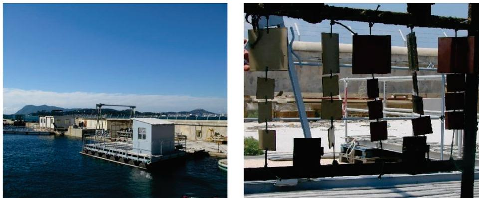
Figure 26 : Radeau et système d'immersion des plaques dans la rade de Toulon
