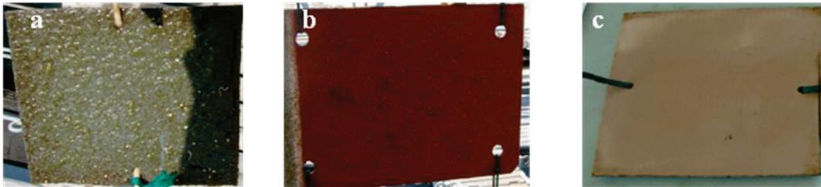
Figure 59 : Recouvrement des plaques après un mois d'immersion pour (a)PVC, (b) IT757 et (c) SL04A.
