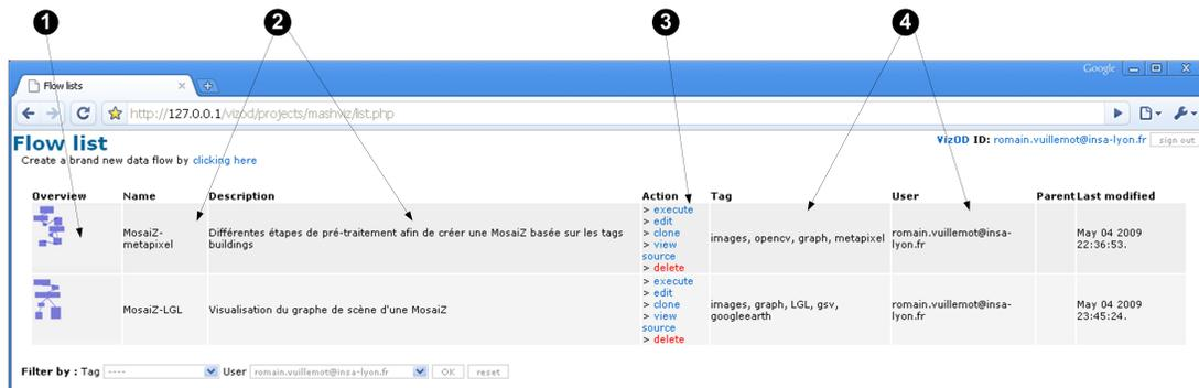
FIGURE 5.8 – Capture d'écran de l'interface MASHVIZ dédiée au partage de flots. Les flots déjà créés sont visibles sous forme de liste qu'il est possible de filtrer par tags ou par utilisateurs.
