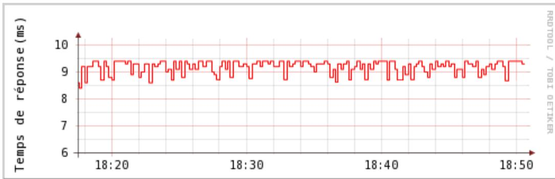
FIGURE 7.4 – Enregistrement du temps de réponse d’un service.
