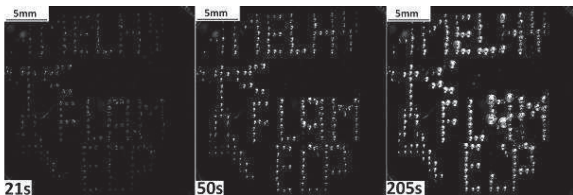
Figure 3.15: Séquence d'images périscopiques d'une cathode verticale polarisée à 150 \text{ A m}^{-2} sur laquelle des îlots de Ni-PTFE ont été disposés. Des bulles d'hydrogène se fixent sur ces îlots
