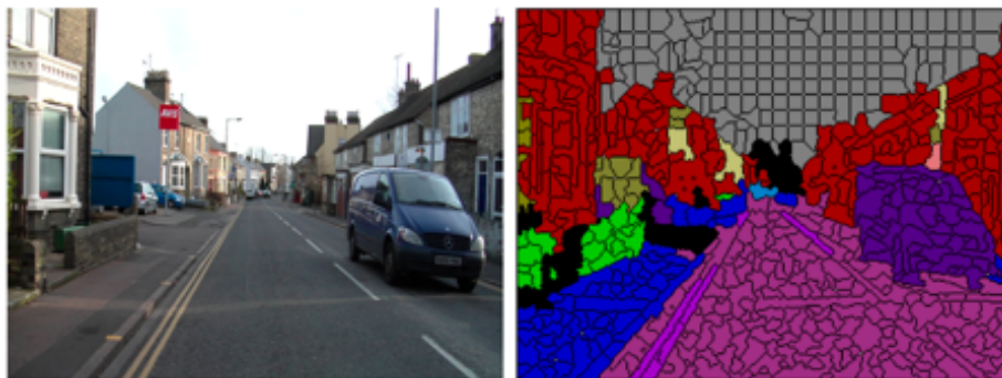
FIGURE 23.: Exemple de résultats obtenus par la méthode de segmentation sémantique sur la base de données « CamVid » (Brostow et al., 2008). Labels : Gris : Ciel, Rose : route, Bleu : Trottoir, Rouge : Batiment, Violet : Véhicules
