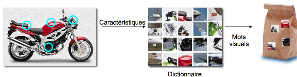
FIGURE 16.: Illustration du codage sous forme de « sac de mots visuels ».
