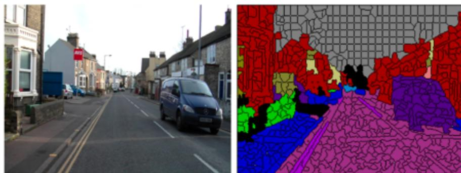
**FIGURE 23.**: Exemple de résultats obtenus par la méthode de segmentation sémantique sur la base de données « CamVid » (Brostow et al., 2008). Labels : Gris : Ciel, Rose : route, Bleu : Trottoir, Rouge : Bâtiment, Violet : Véhicules
