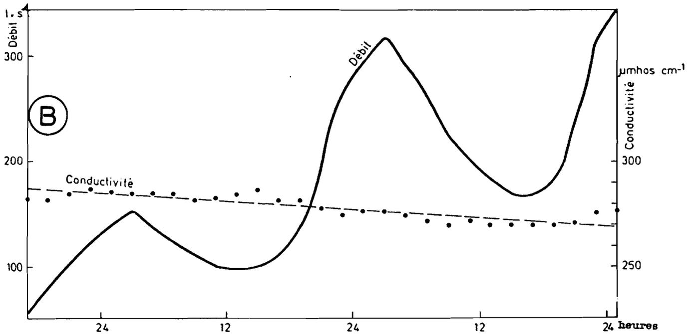
Fig. 130 : REACTION DU DEBIT ET DE LA CONDUCTIVITE AUX CYCLES NYCTHEMERAUX GEL-DEGEL (MAI 1979, (A) : LE PONT DE GYS, (B) : LES PLAGNES (VUYLSTEEK 1983)
