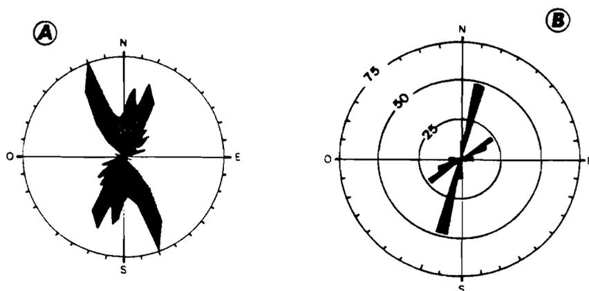
Fig. 30 : FRACTURATION ET ORIENTATION DES CAVITES KARSTIQUES
