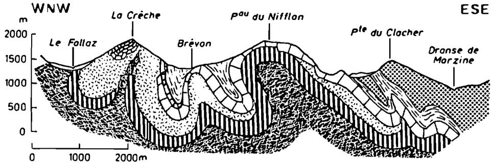
Fig. 22 : MASSIF DU NIFFLON - COUPE GEOLOGIQUE (VUYLSTEEK 1983)
