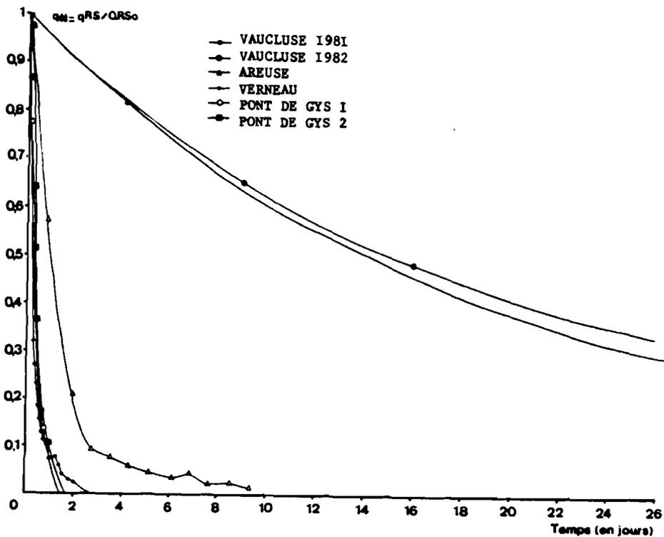
Fig. 146 : COURBES DE DECROUE DE L'INFILTRATION, METHODE PHYSICO-CHEMIE SUR 4 SYSTEMES KARSTIQUES
