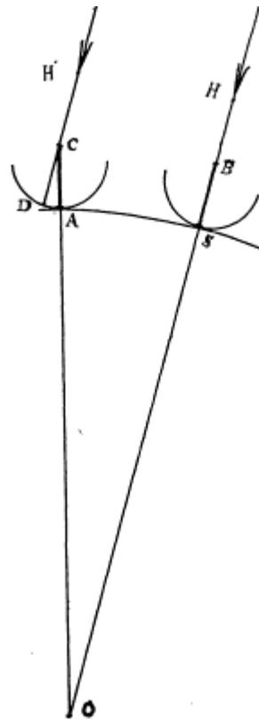
Figure 3 : Schéma représentant la méthode d'Eratosthène telle que décrite par Cléomède. L'arc AD est égal à  $1/50^e$  du cercle de centre C et de rayon [AC]. Comme les angles  $\hat{C}$  et  $\hat{O}$  sont égaux, l'arc AS délimite  $1/50^e$  du cercle terrestre.
