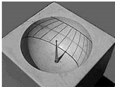
Figure 2 : Photographie d'un cadran solaire hémisphérique ou scaphe
