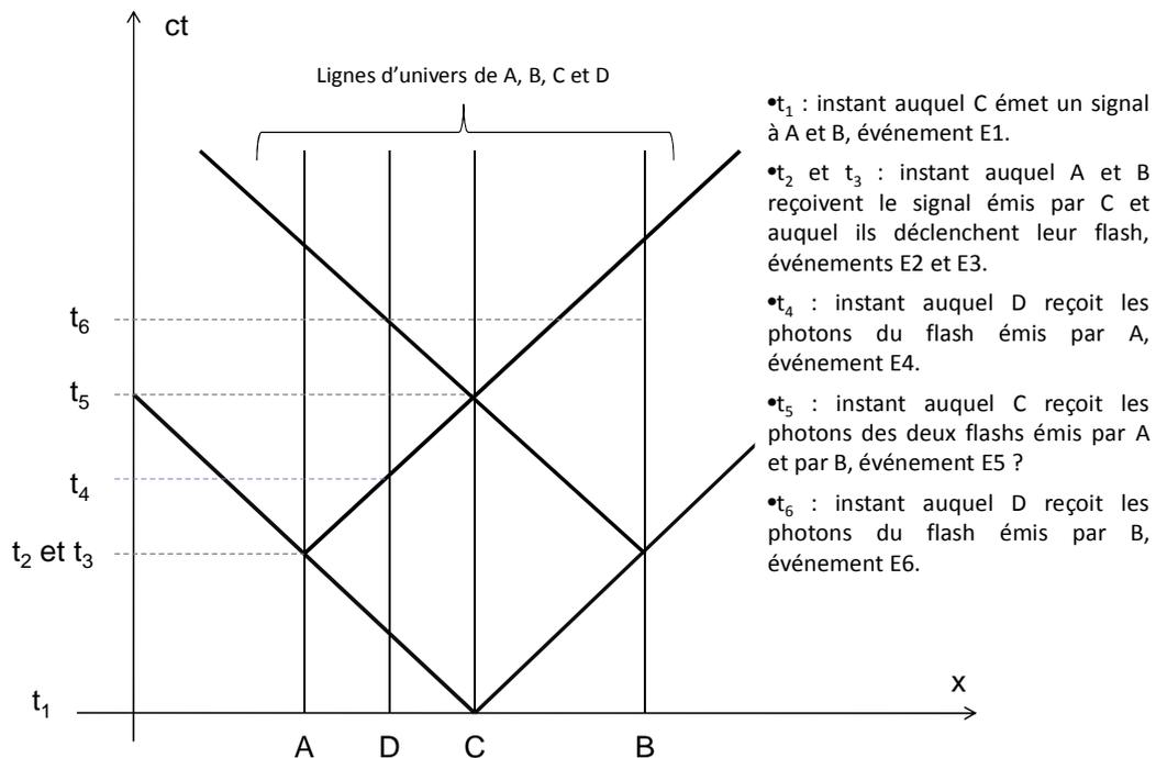
Diagramme d'espace-temps permettant de répondre aux items I2.1, I2.2, I2.3 et I2.4. Les traits épais représentent les lignes d'univers des photons. En choisissant  $ct$  à la place de  $t$  en ordonnée, et des unités identiques pour chacun des axes, la ligne d'univers d'un photon est figurée comme une ligne droite inclinée de  $45^\circ$  par rapport à l'axe des abscisses. Dans ce diagramme, l'instant de chaque événement est donné dans le référentiel du pont.
