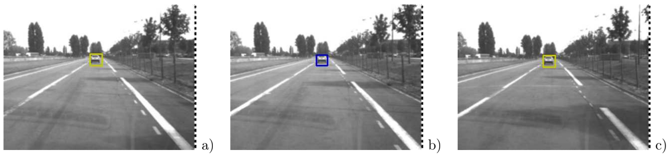
FIG. 3.26 – Détection multi-capteurs lors du suivi d'un véhicule.
