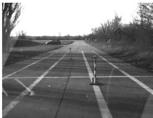
FIG. D.1 – Banc de calibrage du site de Satory utilisé pour réaliser la configuration des différents capteurs.
