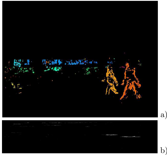
FIG. 2.11 – Filtrage des plans non fronto-parallèles. La barrière a bien été supprimée de l'image de disparité.
