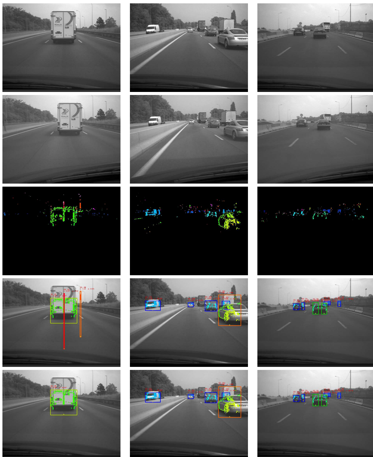
FIG. 5.2 – Résultats obtenus par stéréovision pour la séquence "autoroute". De haut en bas : images de droite, images de gauche, images de disparité, zones d'intérêt détectées, détections confirmées.
