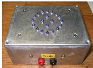
FIG. 3.15 – Prototype de lampe émettrice.
