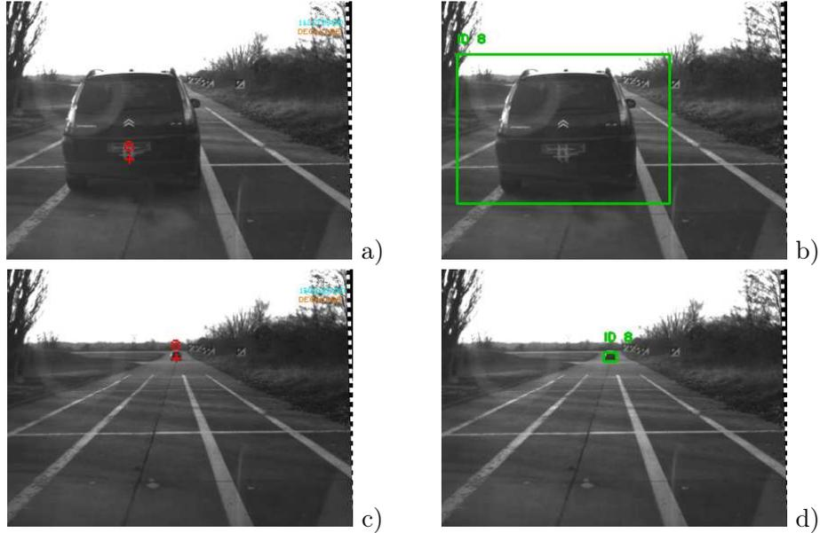
FIG. 3.23 – Identifiants localisés dans l'image de droite de la paire stéréoscopique en utilisant l'identification en stéréovision (a,c) et zones d'intérêt correspondantes (b,d).
