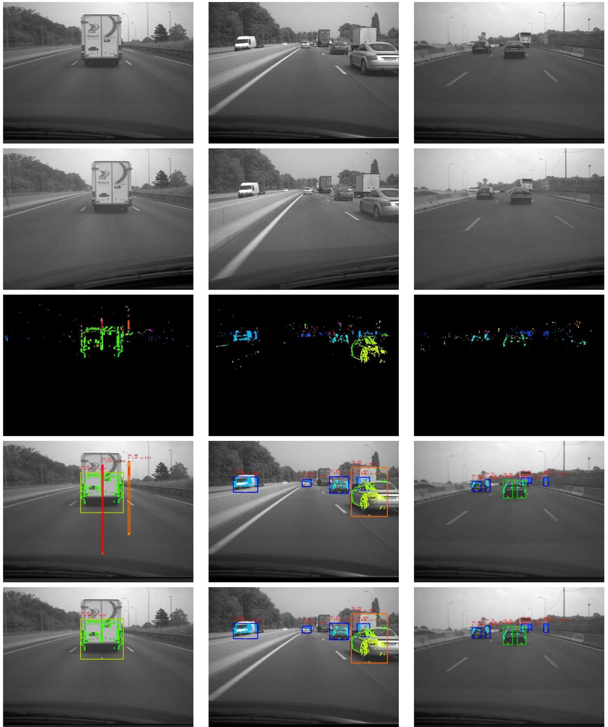
FIG. 5.2 – Résultats obtenus par stéréovision pour la séquence "autoroute".
