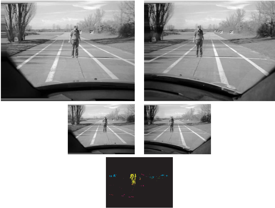
FIG. 3.6 – Réduction d'un facteur 2 d'une paire d'images stéréoscopique par moyennage, et image de disparité obstacle résultante.
