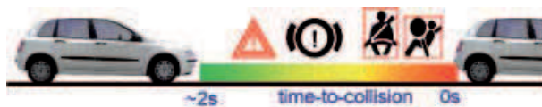
FIG. 2 – Illustration du lien entre le temps à collision et le mode d'action.
