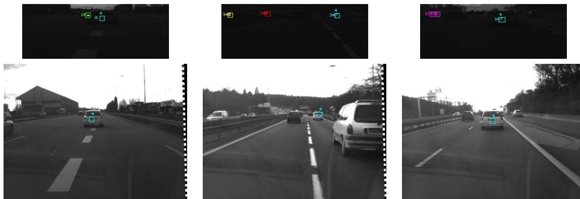
FIG. 5.7 – Illustration de la séquence de test utilisée pour la détection par identification optique. Dans les images infrarouge, seuls les rectangles cyan correspondent à des codes cohérents.
