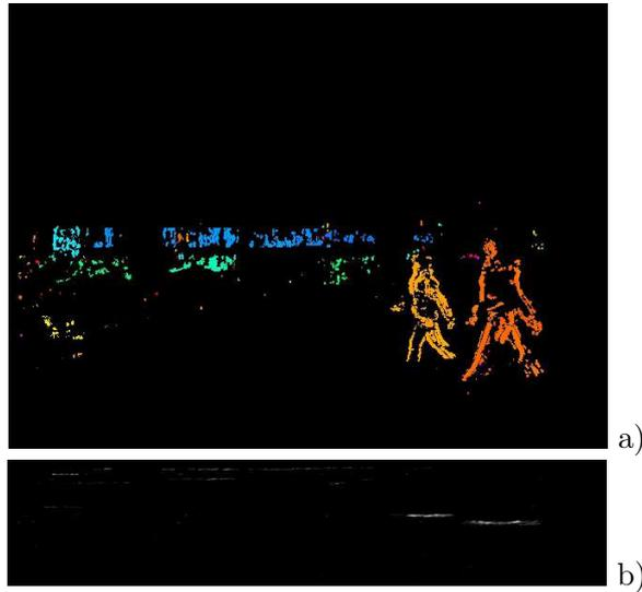
FIG. 2.11 – Filtrage des plans non fronto-parallèles. La barrière a bien été supprimée de l'image de disparité.
