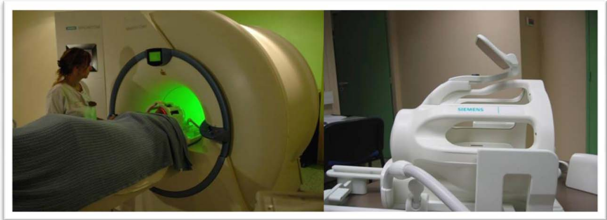
Figure 39: L'IRM Sonata Siemens 1,5 T (à gauche) et l'antenne tête à 8 canaux (à droite)
