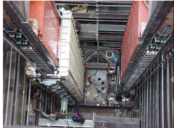
FIGURE 1.45: Générateur linéaire à aimants permanents. Les parties fixes sont en rouge. Une des deux parties mobiles sur lesquelles se trouvent les aimants est installée à gauche [Polinder07]
