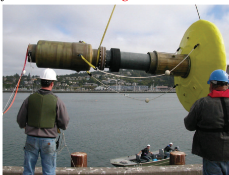
FIGURE 1.52: Prototype du point absorber développé à l'OSU en partenariat avec Columbia Power Technology [Von Jouanne08]
