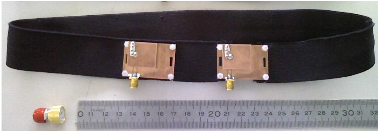
Figure 3.33 : Jeu de PIFA monté sur une ceinture pour être testé sur le corps
