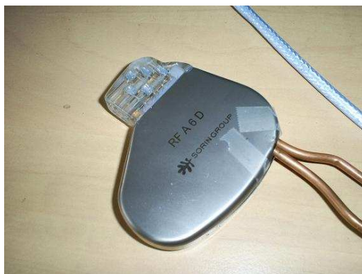
Figure 1.9. Pacemaker muni d'une antenne magnétique pour la bande des 400 MHz
