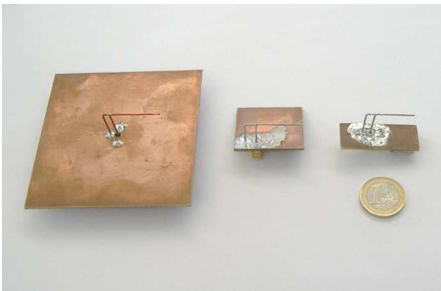
Figure 3.26 : Evolution du plan de masse d'une IFA
