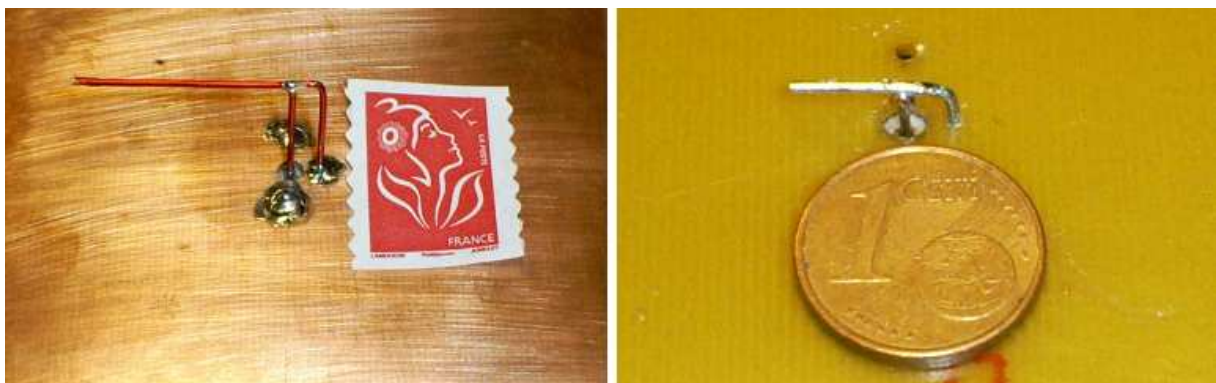
Figure 3.23 : A gauche IFA 1.8 GHz et à droite IFA 5.8 GHz
