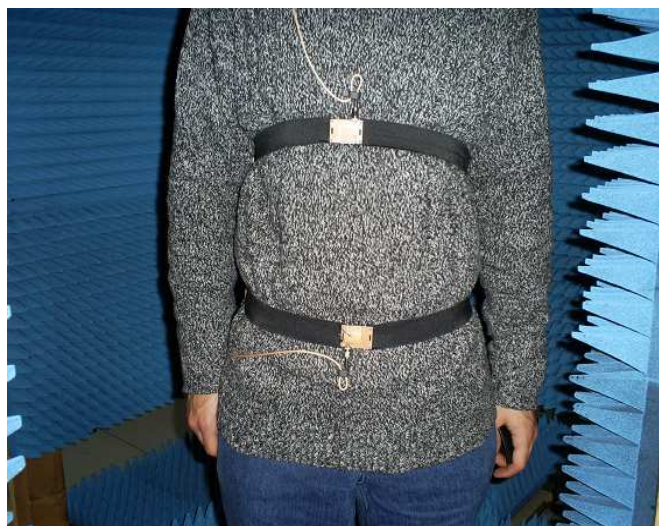
Figure 2.54 : Configuration des antennes pour le trajet torse-torse
