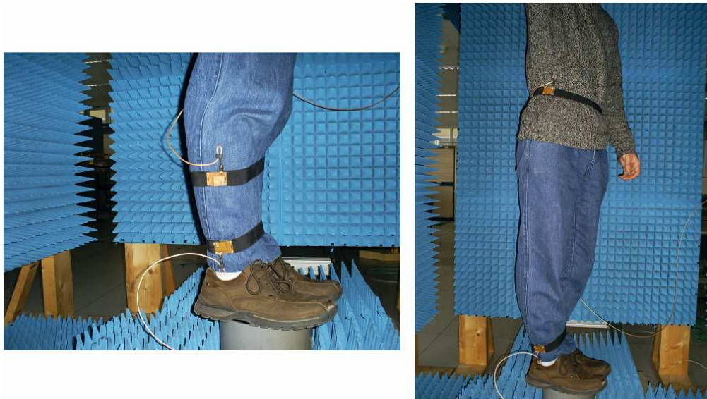
Figure 2.55 : Configuration des antennes pour le trajet cheville-poitrine
