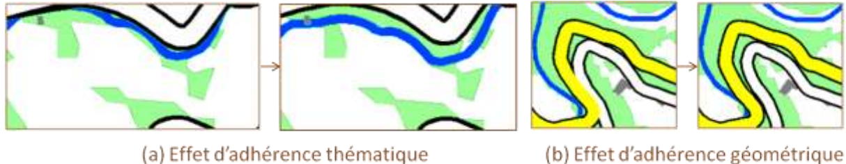
Figure C-78. (a) un effet de bord de type adhérence thématique : le cours d'eau ne passe plus au milieu de la forêt et le voisinage thématique fonctionnel est perdu. (b) effet de bord de type adhérence géométrique : le cours d'eau coulant le long de la route passe sous la route suite à sa généralisation.
