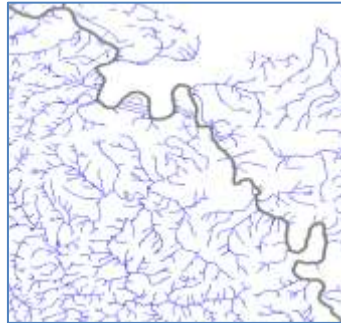
Figure C-8. Exemple d'un 'stroke' dans un réseau hydrographique. Il tire son importance de sa longueur par rapport à l'ensemble du réseau.
