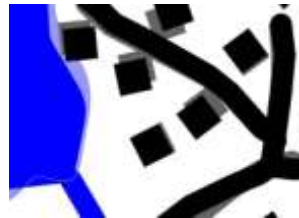
Figure A-14. Généralisation par moindres carrés. Les objets initiaux apparaissent grisés (Harrie et Sarjakoski, 2002).
