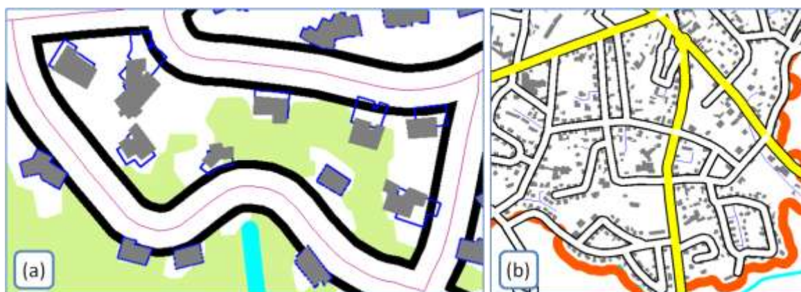
Figure E-6. (a) Algorithme de déplacement implémenté dans CartAGen appliqué sur un îlot urbain. (b) Algorithme d'élimination des rues et impasses appliqué sur le réseau routier d'une petite ville. Les situations initiales sont rappelées en traits bleus fins dans les deux cas.
