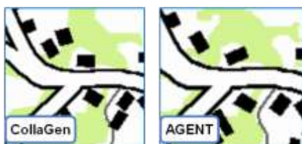
Figure E-56. Zoom sur un extrait de la figure précédente qui montre qu'AGENT n'a pas géré les orientations relatives entre bâtiment et route au contraire de CollaGen qui a utilisé CartACom sur cette zone rurale.
