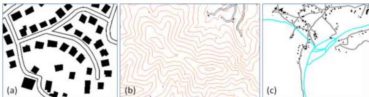
Figure C-13. Trois exemples d'objets meso implicites dans les données. (a) un alignement de bâtiments le long d'une impasse. (b) les courbes de niveau forment un col. (c) ensemble d'île sur un cours d'eau formé par les tronçons hydrographiques.
