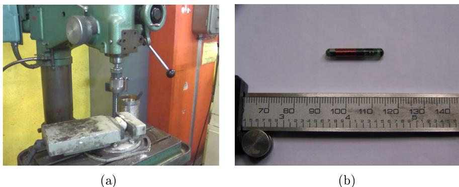
FIGURE 6.29: Dispositif de mise en place des transpondeurs (a) et photo du modèle RI-TRP-WR3P-30 (b).
