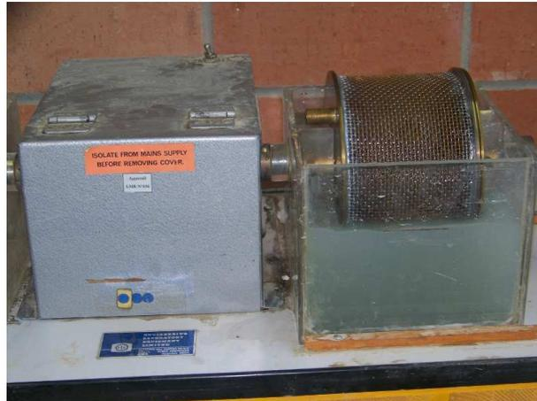
FIGURE 7.5: Dispositif utilisé pour les essais d'altérabilité des marnes de la Loire (matériel du laboratoire de mécanique des roches de l'EPFL).
