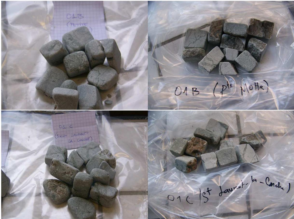
FIGURE 7.7: États de l'échantillon de Petite Motte et L'île Moriaud (de haut en bas) après l'essai d'altérabilité standard (à gauche) et l'essai modifié (à droite).
