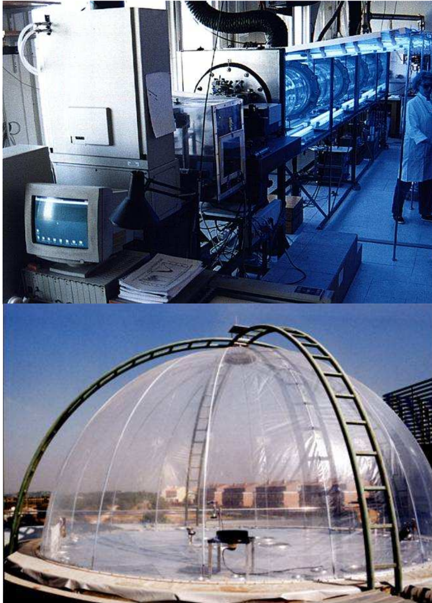
Figure 3: Chambres de simulation atmosphérique : (en haut) du LISA, Créteil, (en bas) d'EUPHORE, Valence.
