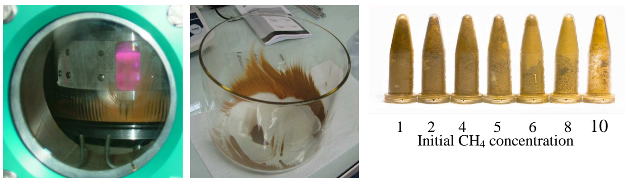
Figure 13 : Photo du dépôt et de la récolte de poudres dans le cristalliseur au bout de quelques heures d'expérience en plasma continu d'azote-méthane.
