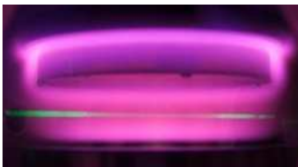
Figure 11 : Photo d'un plasma N_2-CH_4 dans la cavité réactive de PAMPRE ; la trace verte correspond à la diffusion par les poudres en suspension d'un laser vert à 532 nm.
