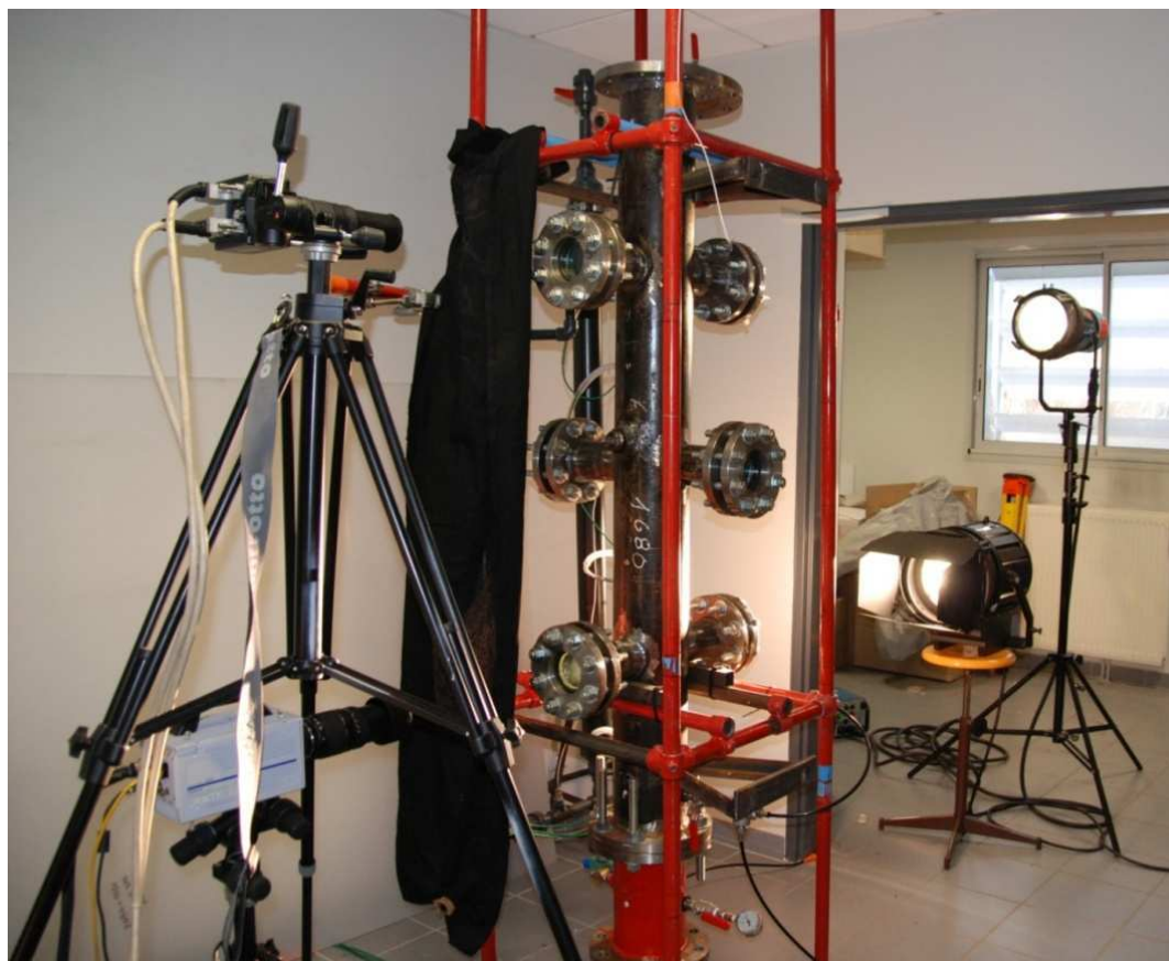
Figure 85 : Dispositif expérimental d'étude de gouttes en chute libre
