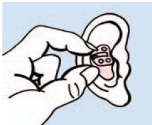
Figure 25 : Prothèse auditive classique intra-conduit. (d'après Siemens)**.
