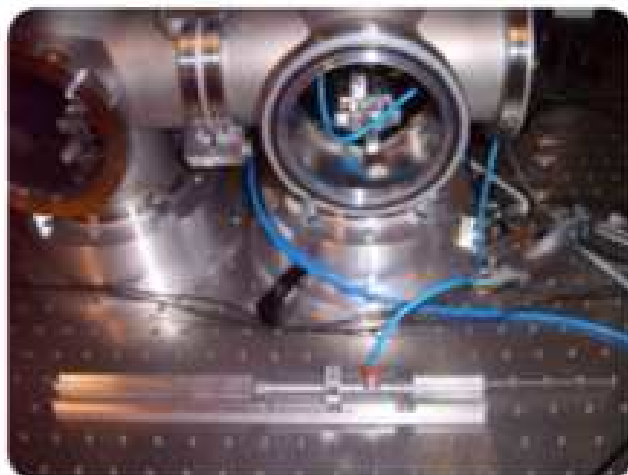
FIGURE 5.4 – Le coeur du dispositif de post compression : le capillaire sur son support avec le circuit d'injection de gaz.
