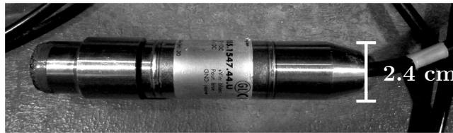
Figure 2.9 – Photo d'un capteur de pression STS.
