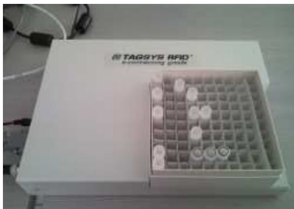
FIGURE 3.5 – Antenne d'inventoriage rapide des boîtes de cryotubes. (Credit : Tagsys)
