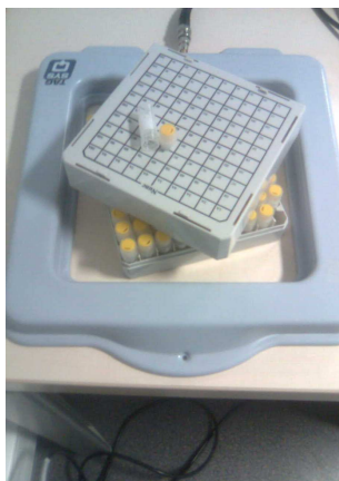
FIGURE 3.3 – Antenne générique, ne permettant pas le positionnement des tubes dans la boîte.
