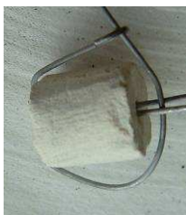
Figure 3-18 : Pastille d'oxyde de cérium poreuse (25 %vol) percée et attachée par une amenée de courant en tungstène
