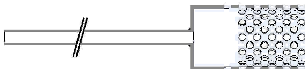
Figure 1-5 : Dessin du support utilisé par Jeong et al. pour maintenir la membrane en MgO poreuse et limiter sa dégradation mécanique. Des trous sont percés pour laisser les éléments diffuser à travers le support.
