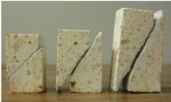
Figure 38 : résultats de compression sur joint incliné sur Mullite MS4R et ciment 337 à 900°C
