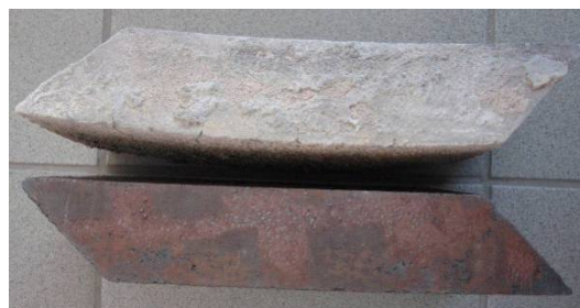
Figure 48 : tuiles d'UVEOM base SiC, en haut après plus d'un an de service, en bas neuve.
