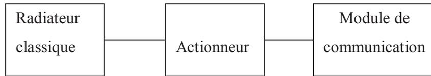
*Figure 5-4 : Structure du radiateur adaptatif*
