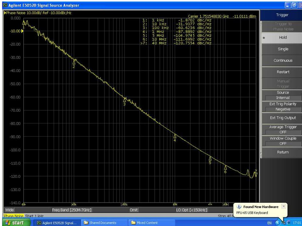
Figure 7-14 : Le bruit de phase dans l'oscillateur OSC\_21\_INV
