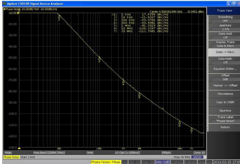
Figure 7-11 : Le bruit de phase dans l'oscillateur OSC\_2T\_3B\_DYN
