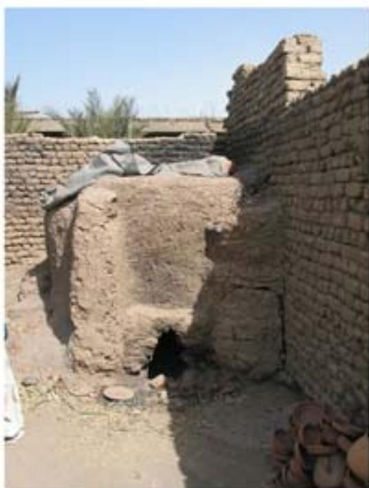
Fig. 4. Four à sole d'un atelier de Hagaza (Haute Egypte),
