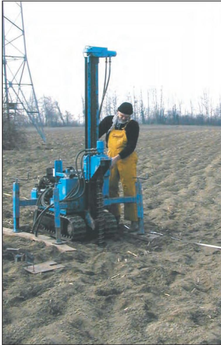
Figure 3.31 : Appareil de forage mécanique en cours d'utilisation au niveau du paléochenal oriental. Cet appareil tout terrain permet à la fois le prélèvement de cuttings à la tarière ou de colonnes.
