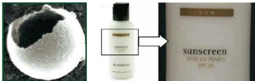
**Figure 19** : Microcapsule hybride à base de silice pour le relargage contrôlé des principes actifs [1]
