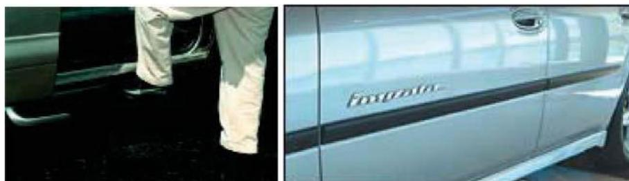
**Figure 16:** Deux des premières applications commerciales de nanocomposites dans l'automobile : à gauche, les marches-pieds de mini-vans Chevrolet et GMC et à droite, des baguettes de protection latérale [79].
