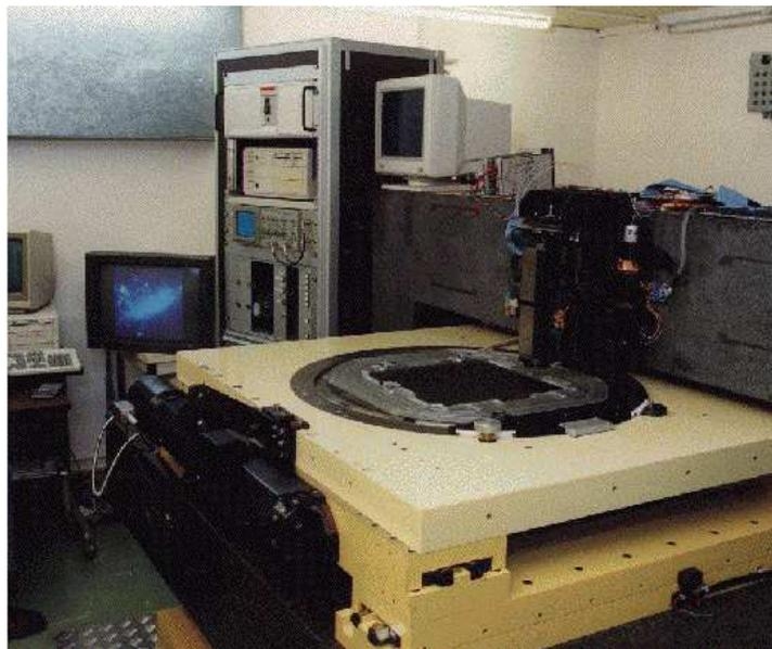
**Figure 3.4** – Machine Automatique à Mesurer pour l'Astronomie (MAMA).
