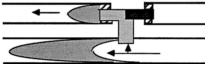
Fig.B25: Représentation schématique des nuages de traceur au niveau du robinet trois voies central.
