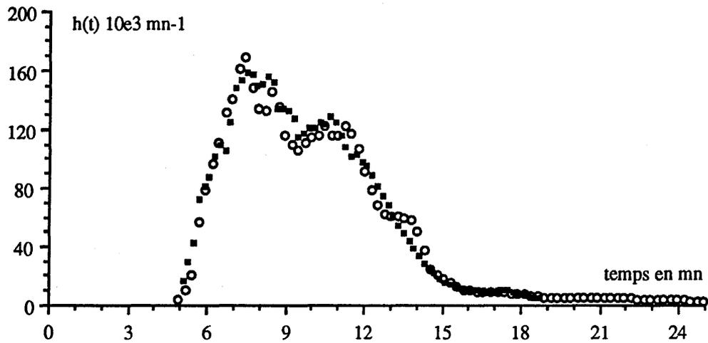
Fig.B30: Comparaison entre la réponse impulsionnelle (391 ml/mn) transformée pour un débit de 620 ml/mn (Cercles) et le résultat expérimental (Carrés noirs)
