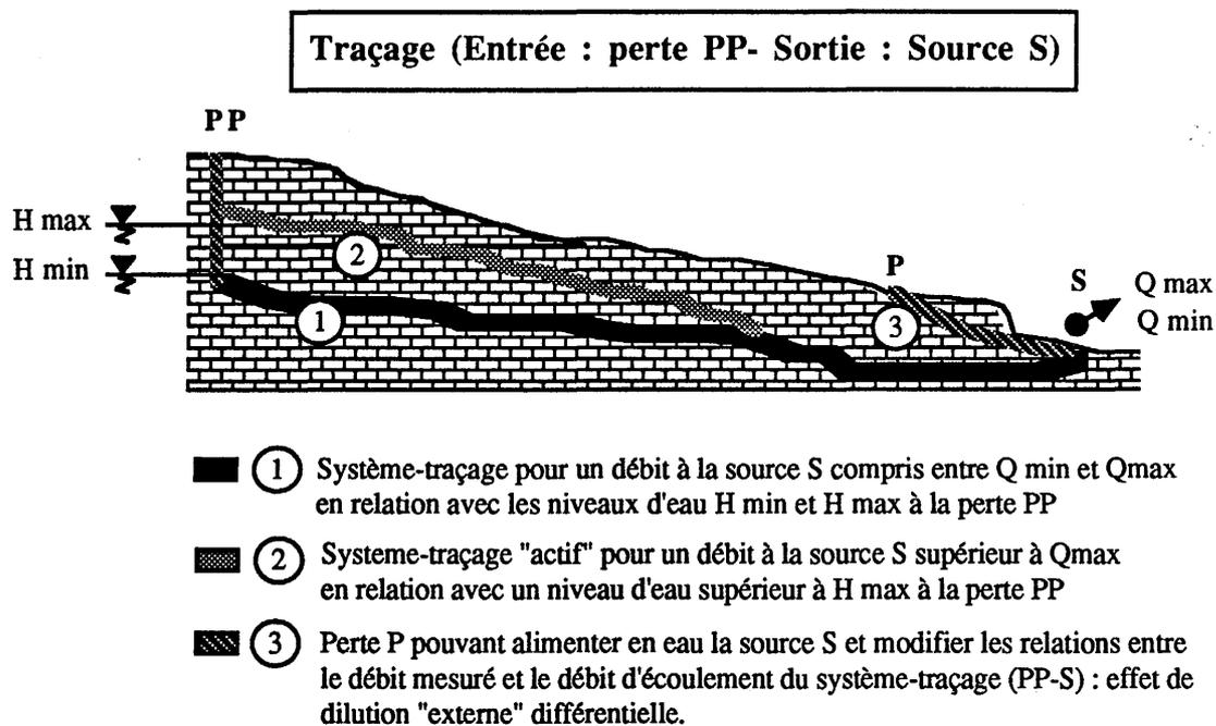
Fig.C38 : Illustration de la limite de la méthode de transformation dans une gamme de débits mesurés à la sortie d'un système à volume constant.
