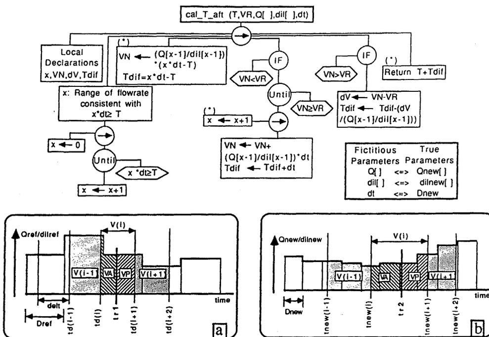
Fig.B43: Cal\_T\_aft(): calcul des temps équivalents supérieurs à  $tr_2$  pour le traçage simulé. Lorsque  $T = T_{new}[i+1]$  et  $VR = V_{i+1}$ , la fonction renvoie  $T_{new}[i+2]$ .
