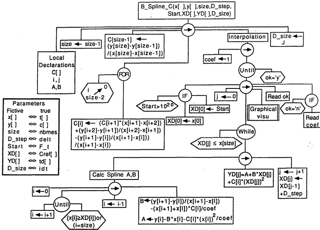
Fig.B35: Méthode d'interpolation utilisant une fonction B\_Spline de degré 2:  $y[] = C[] * x[]^2 + B[] * x[] + A[]$ .  $x[]$  et  $y[]$ : valeurs initiales, Size: nombre de couple  $(x[], y[])$ . La fonction interactive permet la modification de "coef" divisant les valeurs initiales de  $C[]$ .  $YD[], XD[]$  valeurs discrètes interpolées au pas  $D\_step$ ,  $D\_size$ : nombre de couple  $(XD[], YD[])$ .
