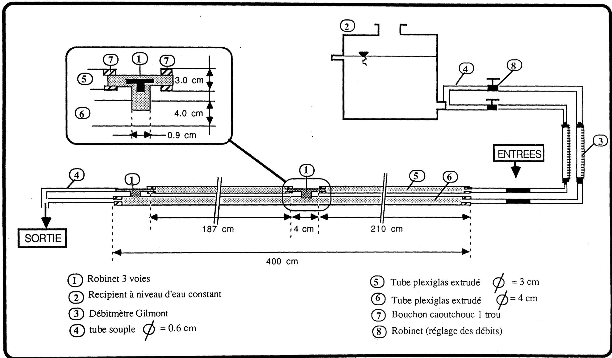
Fig.B17: Dispositif général de la colonne expérimentale.
