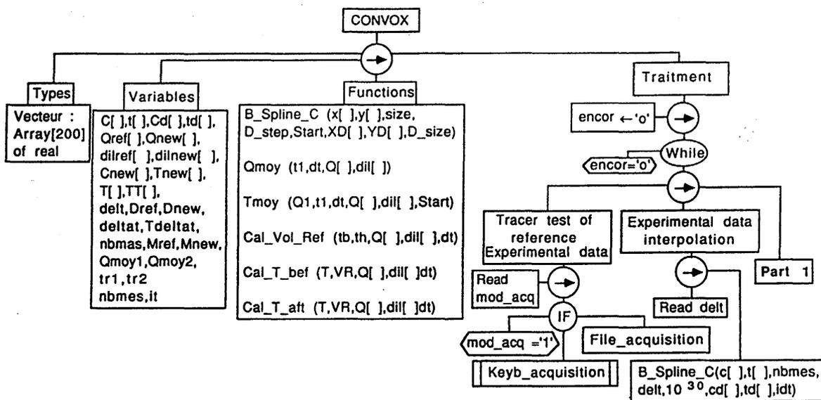
Fig.B34: Programme CONVOX, déclarations des variables et fonctions, traitement des données.
