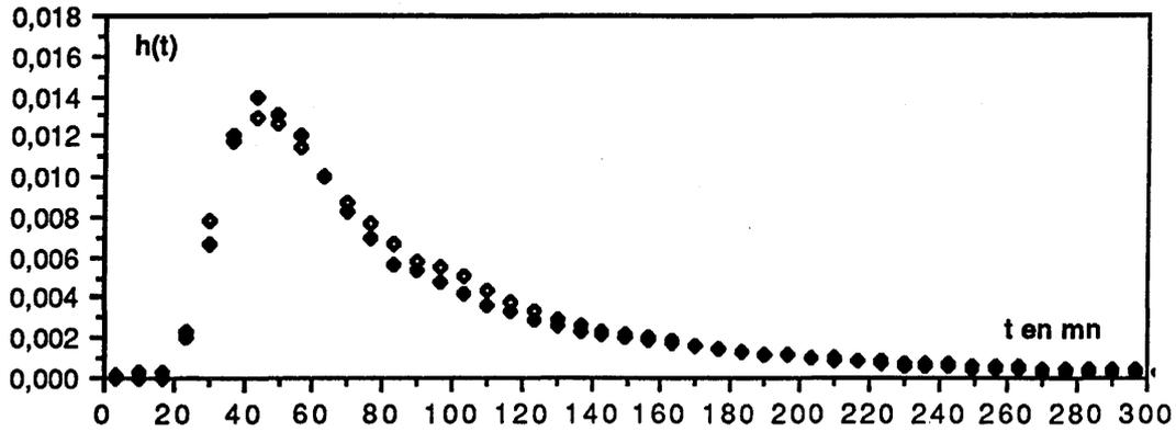
Fig.B32: comparaison de la réponse impulsionnelle transformée au résultat expérimental. ♦  $h(t)$  ( $Q=89,16$  ml/mn) obtenue à partir de  $h(t)$  ( $Q=148$  ml/mn), ◊  $h(t)$  ( $Q=89,16$  ml/mn) expérimentale
