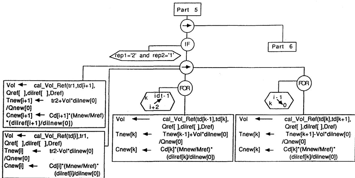
Fig.B39: Algorithmes de transformations. Part 3: Transformation débit constant-débit constant, définie par rep1='1' et rep2='1', Part 4: Transformation débit constant-débit variable, définie par rep1='1' et rep2='2', Part 5: Transformation: débit variable-débit constant, définie par rep1='2' et rep2='1'
