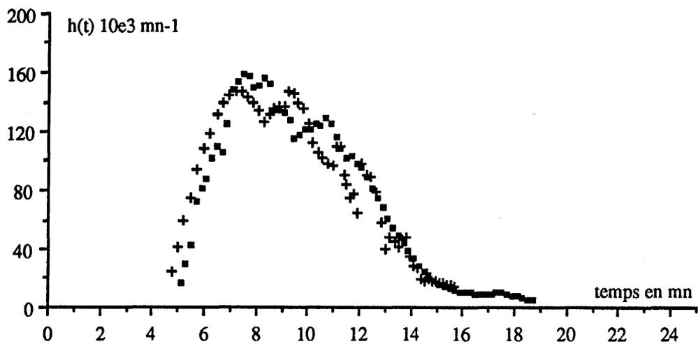
Fig.B31: Comparaison entre la réponse à débit variable (traçage n°3) transformée pour un débit de 620 ml/mn (Croix) et le résultat expérimental (Carrés)
