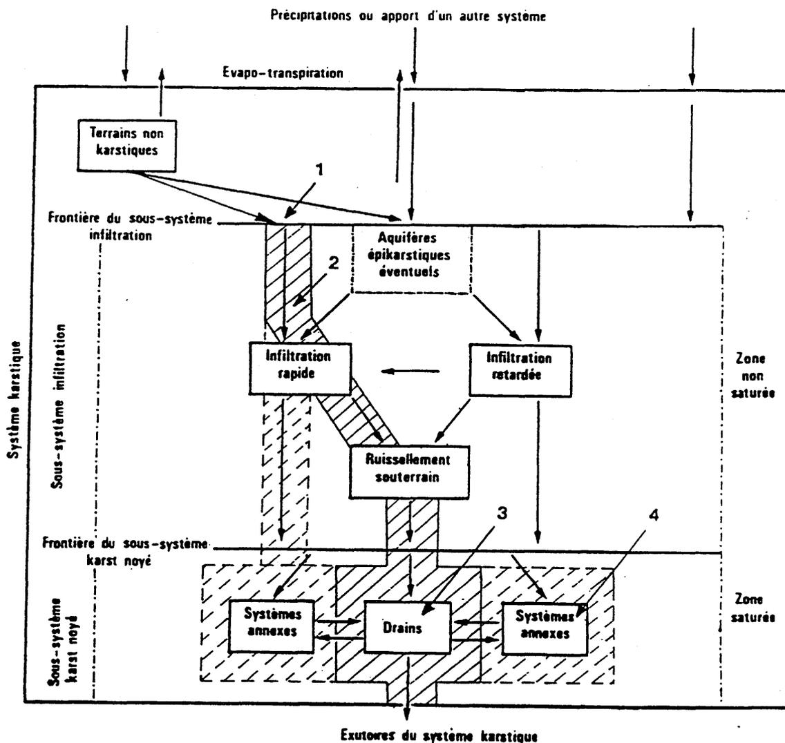
Fig.C2: Représentation du système traçage dans le cadre du système karstique (tiré de Lepiller et Mondain, 1983, modifié d'après Mangin, 1975)). 1: injection à partir de la perte d'un écoulement superficiel. 2: injection à partir d'une cavité siège d'un écoulement. 3: injection dans un drain. 4: injection dans un système annexe.
