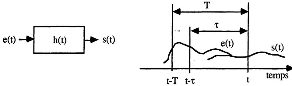
Fig.A3 : Schéma des temps associés au principe de convolution.
