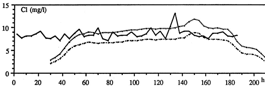
Fig.C30: Résultat à Besaces des convolutions des entrées en chlorure à Thémines et Théminettes. Trait plein: concentrations à Besaces, tirets points: calcul à partir de la masse injectée. Pointillés: calcul à partir de la masse restituée.
