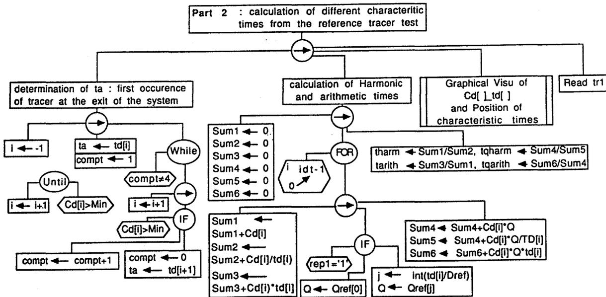
Fig.B38: détermination des temps caractéristiques du RTT à partir des valeurs discrètes de débits et de dilutions  $Q_{\text{ref}}[]$  et  $D_{\text{ref}}[]$  au pas "Dref", et des couples  $(td[], cd[])$  au pas "delt".
