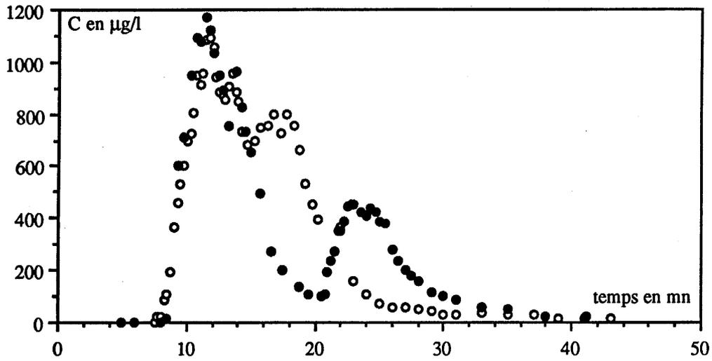
Fig.B28: Résultat des traçages n° 2 et 4 (2e série). Cercles: n° 4 (391 ml/mn),
