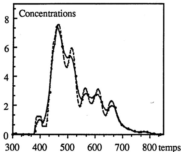
Fig.B36: Exemple d'oscillations limitées par les valeurs de "coef" pour la méthode d'interpolation utilisant une fonction B\_Spline\_Carrée. Carrés noirs: concentrations mesurées. Tirets : interpolation (coef=1). Trait plein: interpolation (coef=3).
