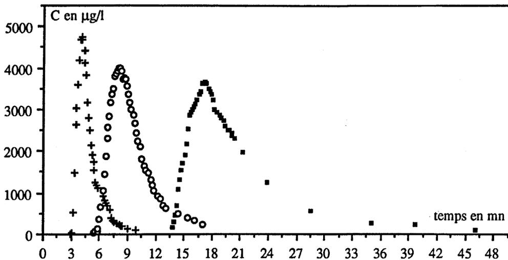
Fig.B19: Résultat des traçages n° 1,2 et 3 (1ere série). Croix: n° 3 (640 ml/mn), Cercles: n°2 (320 ml/mn), Carrés noirs: n°1(148 ml/mn)
