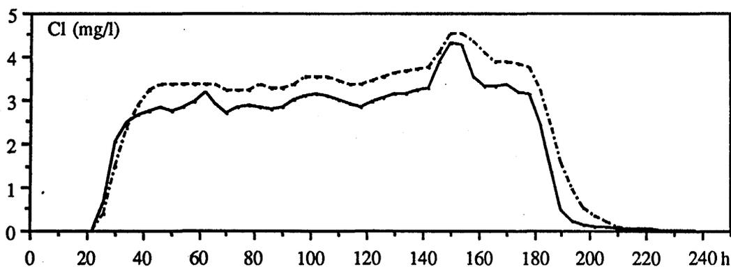
Fig.C28: Comparaison des résultats à Besaces de convolution des entrées en chlorure.(Thémimes-Besaces). Trait plein: à partir du traçage de Février 1988, tirets: à partir du traçage de Mai 1987.
