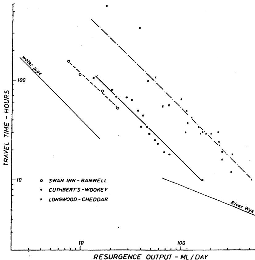
Fig.C3: Relation log-log entre le temps moyen de transfert et le débit d'écoulement du Mendip souterrains. Comparaison avec un écoulement en tube sous pression et une rivière de surface (d'après Stanton et Smart, 1981)
