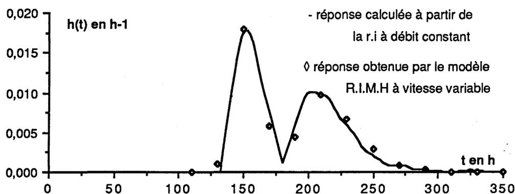
Fig.B16 : comparaison des réponses impulsionnelles obtenues par le modèle R.I.M.H et par transformation (débit constant-débit variable)
