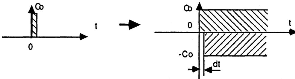
Fig.B4 : signal d'entrée, cas d'une injection brève.
