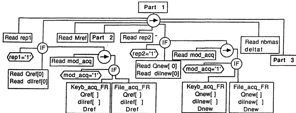
Fig.B37: Part 1 : Acquisition des données de débits et de dilutions relatives aux RTT et STT. Qref[] et Dilref[] : valeurs de débits et de dilutions au pas Dref. Qnew[] et Dilnew[] : valeurs de débits et de dilutions au pas "Dnew".nbmas: nombre de masses injectées au pas deltat pour le STT.
