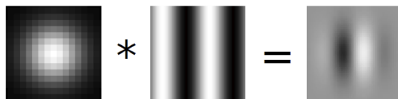
FIGURE 1.4.9: Exemple de construction d'un filtre de Gabor, avec la représentation imagée d'une gaussienne à gauche, d'un sinus au centre, et enfin du filtre obtenu à droite
