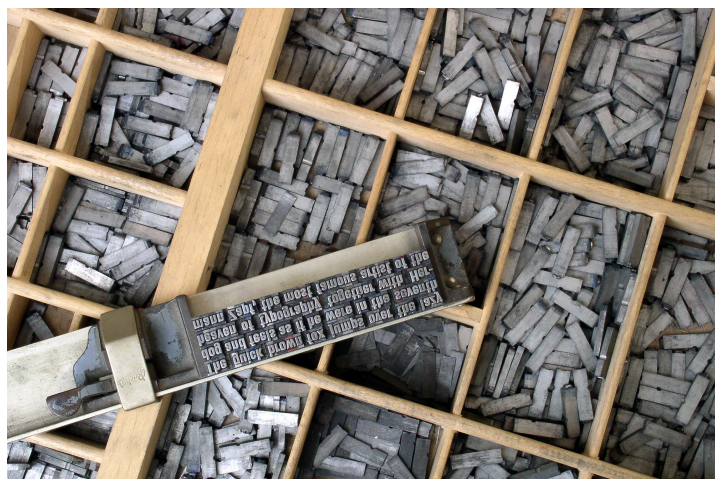
FIGURE 0.0.1: Image de matrice et de tampons utilisés dans l'imprimerie. Les premiers exemplaires, créés au début de l'imprimerie, étaient fabriqués en bois. Ce n'est qu'à partir du XVIII ème siècle, avec l'évolution de l'imprimerie, que les tampons et matrices ont été fabriqués en métal
