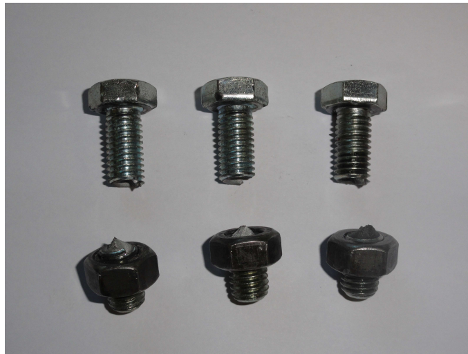
Figure 3.5.13 – Photo des boulons fracturés
