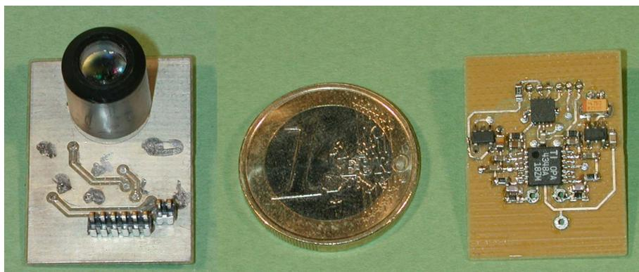
*Figure IV.23* Photographie des 2 faces du DEM mixte (ensemble lentille-photorécepteur inclus) mis en œuvre sur un circuit imprimé d'une épaisseur de 400 $\mu$ m.
