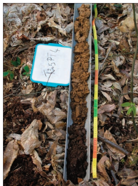
Photo 20. Sondage effectué à la tarière sur la commune de Pluvigner dans le cadre du programme « Sols de Bretagne »
