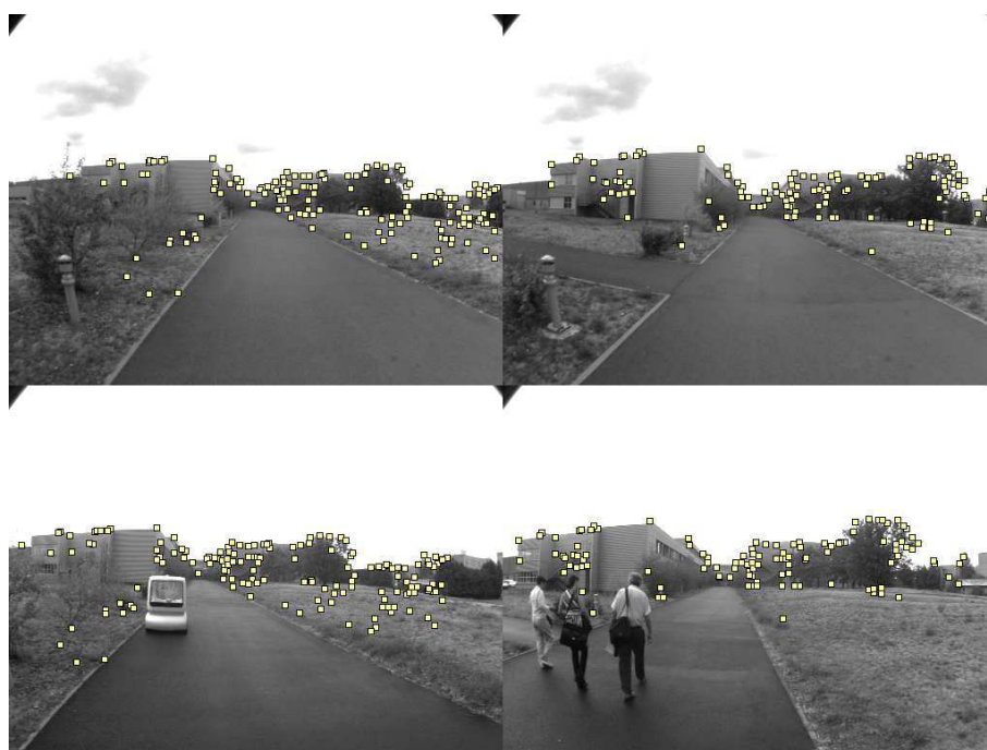
FIG. 5.22 – Points d'intérêt correctement appariés entre l'image de référence et l'image courante. A gauche : quand le robot est proche de la trajectoire d'apprentissage. A droite : quand l'écart latéral par rapport à la trajectoire d'apprentissage est maximal (3 m). L'image clef est en haut.
