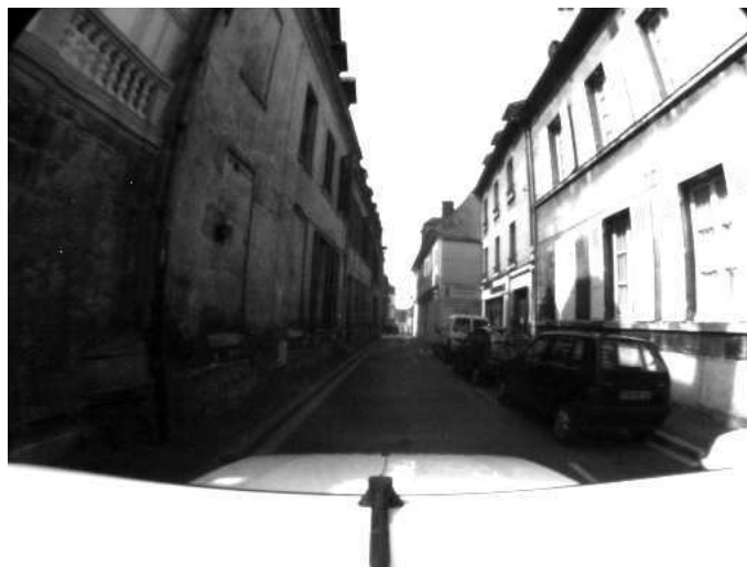
FIG. 5.37 – Manque de dynamique de la caméra : une partie de l'image est sous-exposée alors qu'une autre partie est surexposée.
