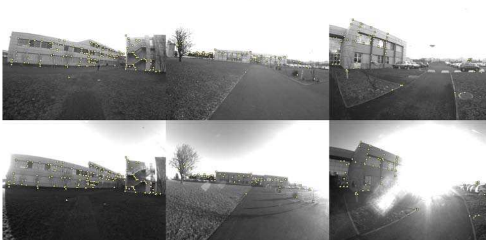
FIG. 5.17 – Trois images prises pendant la navigation autonome du cycab (en bas) et les images clef correspondantes (en haut). Les points d'intérêt utilisés pour le calcul de pose sont en surimpression.
