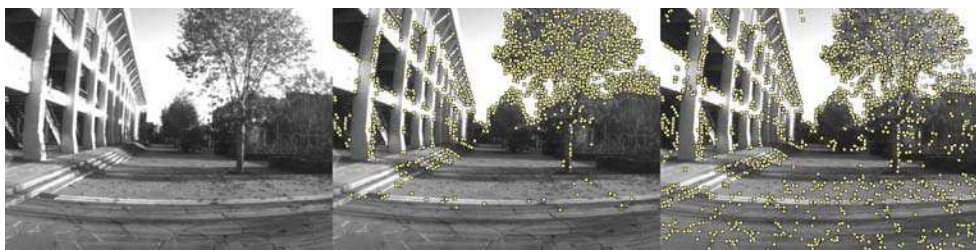
FIG. 2.4 – Détection de points d'intérêt. A gauche, l'image originale, au milieu les 1500 meilleurs points d'intérêt, à droite les points détectés en utilisant la sélection par baquets. L'utilisation de baquets permet d'obtenir des points mieux répartis dans l'image.
