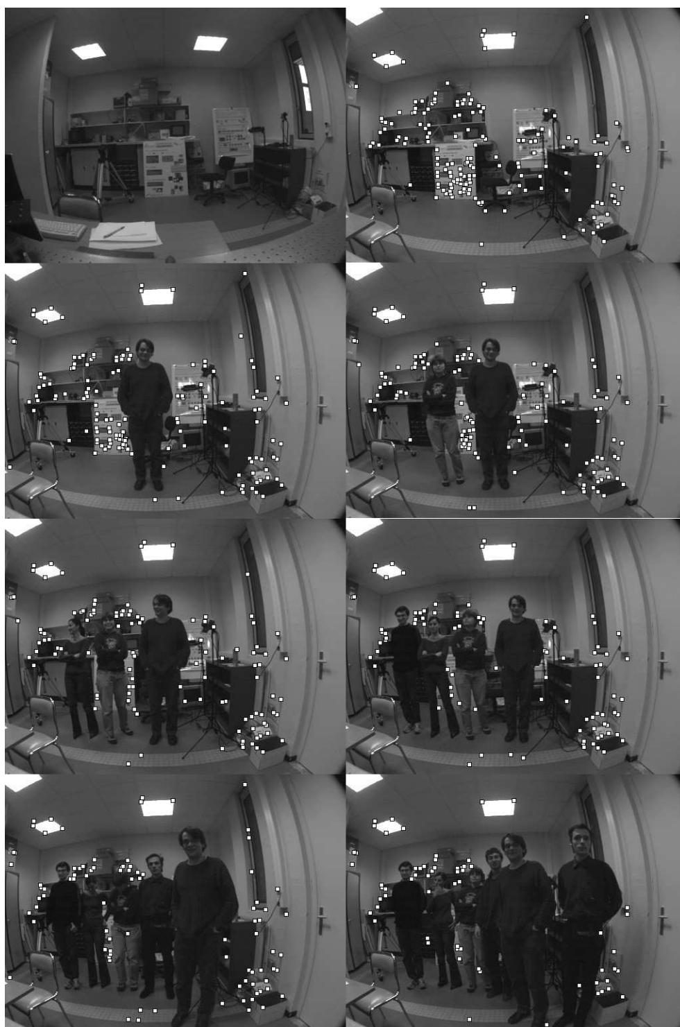
FIG. 5.30 – Evaluation de la robustesse aux occultations (caméra à 1 m à côté de la trajectoire d'apprentissage). L'image de référence est en haut à gauche.
