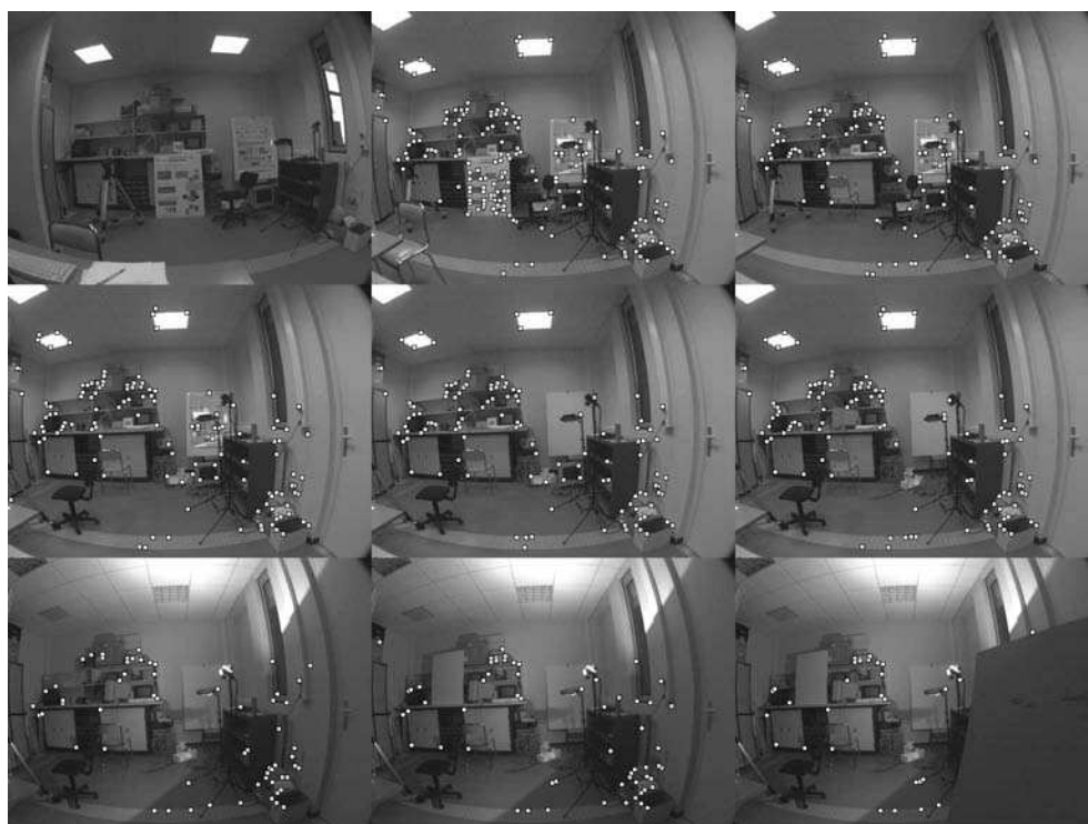
FIG. 5.32 – Evaluation de la robustesse aux changements dans la scène (caméra à 1 m à côté de la trajectoire d'apprentissage)
