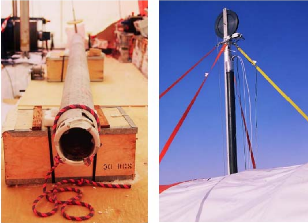
Figure III-1 : carottier électromécanique et manchon utilisés pour le forage et le prélèvement d'air dans le névé, lors de la mission réalisée à Berkner Island (Antarctique).
