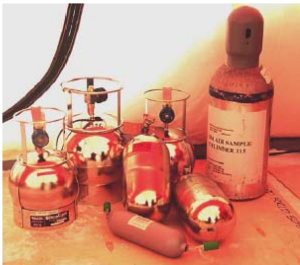
Figure III-5 : Photo des différentes bouteilles de prélèvement utilisées lors de la mission à Berkner Island (Antarctique).
