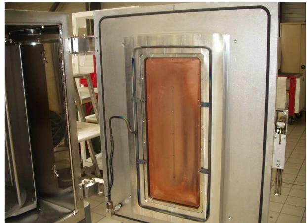
Figure 5.17: Cathode magnétron du réacteur de démonstration.
