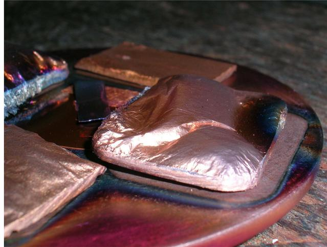
Figure 4.3: Substrats endommagés lors du dépôt de cuivre. Pression: 5 Pa,  $I_{Mag}$ : 500 mA,  $P_{RF}$ : 200 W Boucle découplée de la masse; substrat au potentiel flottant  $V_f$
