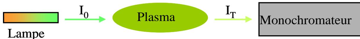
Figure 2.8: Schéma de principe de la technique de spectroscopie d'absorption résonnante
