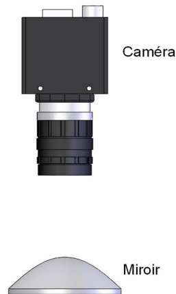
Figure 36: Exemple de capteur catadioptrique.
