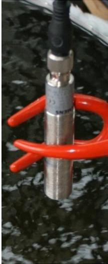
Figure 32: Capteur de niveau Siemens M18
