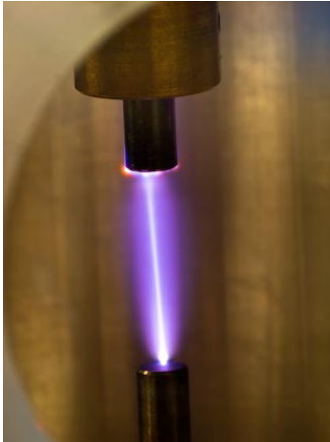
FIGURE 5.17 – Photographie en pause longue d'une transition glow-arc
