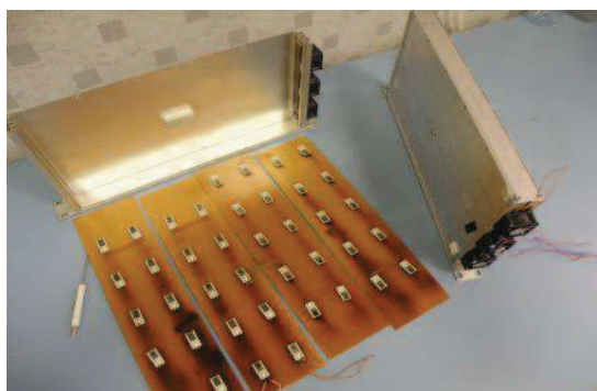
Figure II.3. Photo des boîtiers dissipateurs de la chaleur
