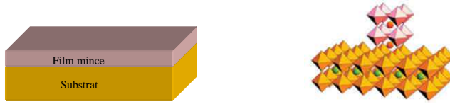
Figure I-17 : représentation du couplage film/substrat et de leur structure pérovskite.
