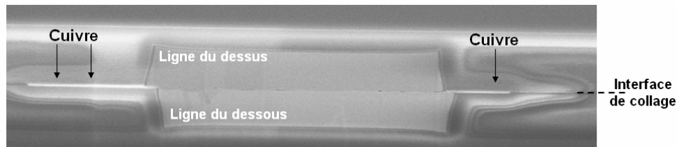
Figure III. 42 : Image MEB de deux lignes collées présentant une extrusion du cuivre après test d'électromigration. L'accumulation du cuivre à cet endroit le fait extruder au niveau de l'interface de collage oxyde – oxyde.
