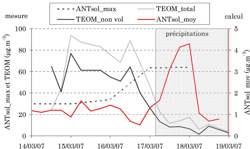
**Figure A-16. Moyenne spatiale des concentrations en particules anthropiques modélisées toutes les 6 heures (axe de droite), concentrations maximales observées sur la grille 4 et masse (totale et non volatile) mesurée à Opme.**
