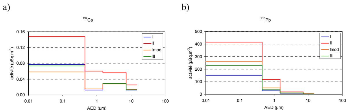
**Figures III-17. Distribution en taille du  $^{137}\text{Cs}$  (a) et du  $^{210}\text{Pb}$  (b) aux Cézeaux en fonction du caractère marin (I), continental (II), marin modifié (I<sub>mod</sub>) et méditerranéen (III) de la masse d'air, en  $\mu\text{Bq}\cdot\text{m}^{-3}$ .**
