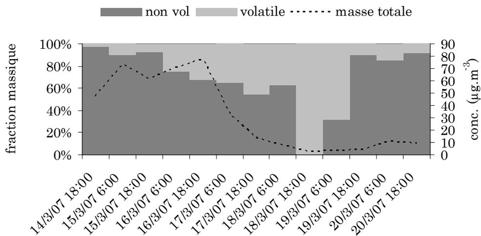
**Figure A-7. données TEOM (valeurs moyennes toutes les 12 heures) à Opme du 13 au 20 mars 2007. Les histogrammes représentent les fractions volatile et non volatile (axe de gauche) et la masse totale est représentée par la courbe pointillée (axe de droite).**
