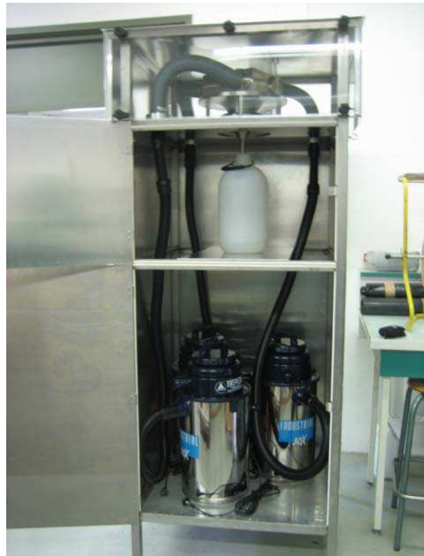
Figure II-19. Photos de l'impacteur à brouillard automatique.
