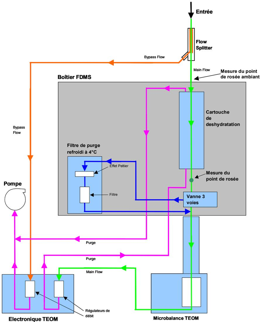
Figure II-15. Schéma de principe du TEOM FDMS 8500C.
