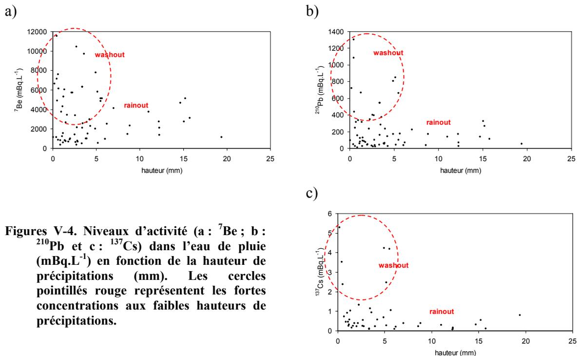
Figures V-4. Niveaux d'activité (a :  $^7\text{Be}$  ; b :  $^{210}\text{Pb}$  et c :  $^{137}\text{Cs}$ ) dans l'eau de pluie ( $\text{mBq.L}^{-1}$ ) en fonction de la hauteur de précipitations (mm). Les cercles pointillés rouge représentent les fortes concentrations aux faibles hauteurs de précipitations.
