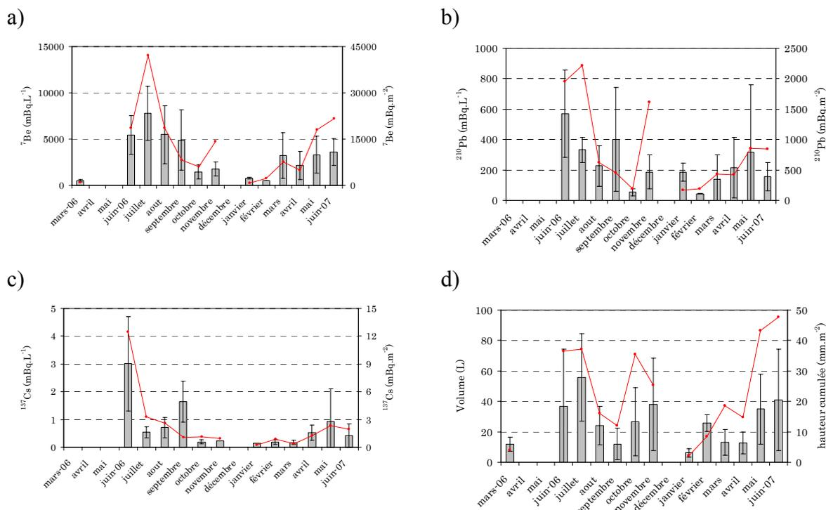
**Figure V-2. Moyenne mensuelle des niveaux d'activité du  $^7\text{Be}$  (a), du  $^{210}\text{Pb}$  (b) et du  $^{137}\text{Cs}$  (c) (en  $\text{mBq}\cdot\text{L}^{-1}$ ) mesurés aux Cézeaux, représentée par les histogrammes. Les activités surfaciques ( $\text{mBq}\cdot\text{m}^{-2}$ ) sont présentées sur l'axe de droite (courbe rouge). La figure d) représente les volumes d'eau de pluie moyens mensuels prélevés, en L. Les barres d'erreurs représentent l'écart type des données.**
