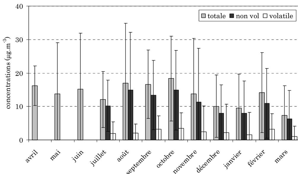
**Figure III-1. Concentration mensuelle et écart type de la masse d'aérosol (masse totale en gris clair, masse non volatile en gris foncé et masse volatile en blanc) au puy de Dôme d'avril 2007 à mai 2008.**
