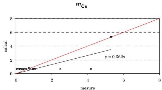
**Figures V-5. Concentrations calculées en fonction des concentrations mesurées (en mBq.L<sup>-1</sup>). Les niveaux d'activité (a :  ${}^7\text{Be}$ , b :  ${}^{210}\text{Pb}$  et c :  ${}^{137}\text{Cs}$ ) sont calculés dans l'eau de pluie suivant la relation V.1 et les coefficients a, b, et k trouvés expérimentalement.**
