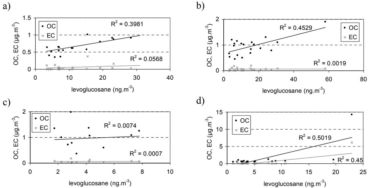
**Figures III-15. Concentrations en OC et EC ( $\mu\text{g}\cdot\text{m}^{-3}$ ) en fonction du levoglucosane ( $\text{ng}\cdot\text{m}^{-3}$ ) au puy de Dôme suivant chaque saison (a : hiver, b : printemps, c : été et d : automne).**
