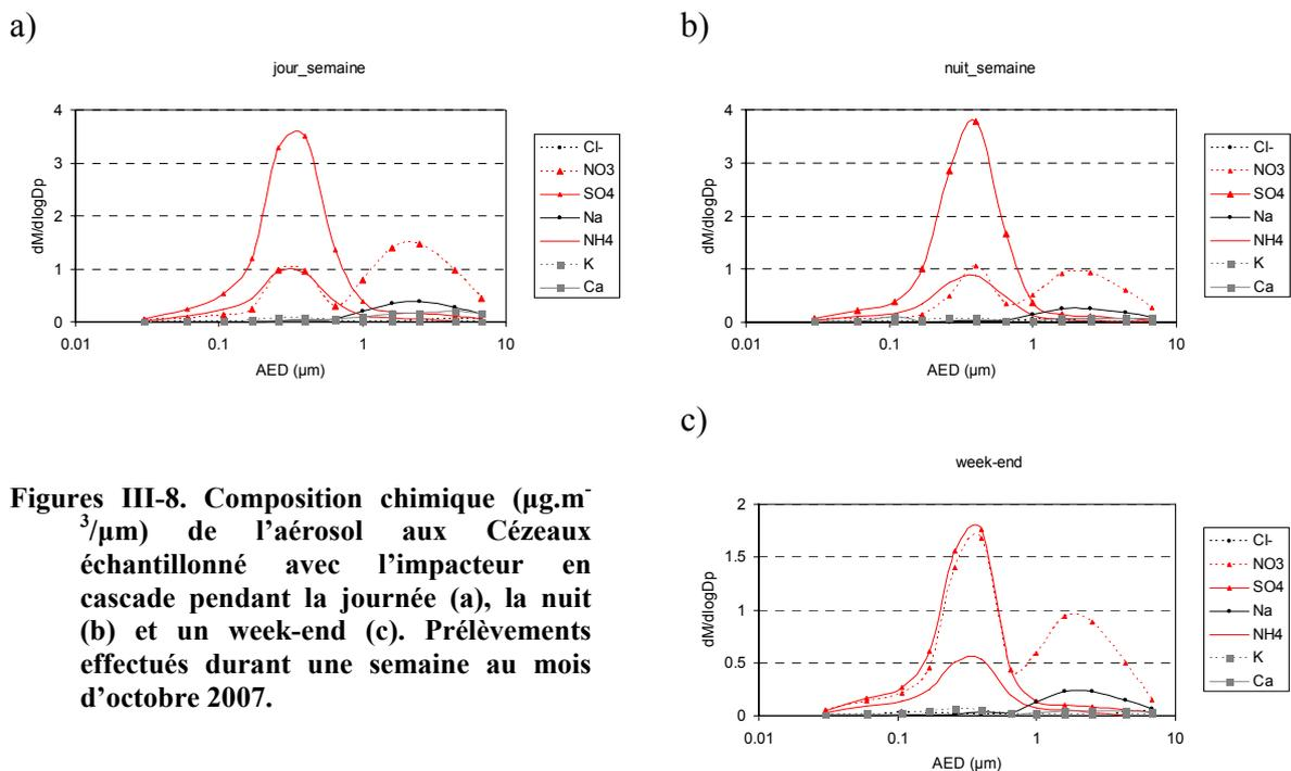
La distribution de l'aérosol ainsi que sa composition chimique sont les mêmes durant la semaine malgré un changement d'origine de masse d'air d'un secteur Est vers un secteur Sud puis Nord. La distribution est bimodale avec un mode d'accumulation constitué principalement de nitrate, sulfate et ammonium et un mode grossier composé de nitrate et sodium. Aucune différence de composition n'est observée entre les échantillons de jour et
