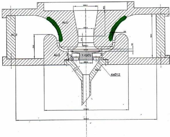
Figure II-18. Schéma de la tête de prélèvement.
