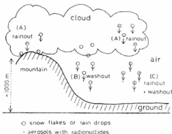
**Figure I-4. Schéma résumant les différents processus de lessivage (Ishikawa et al., 1995). (a) lessivage par du rainout uniquement, (b) lessivage par du washout uniquement et (c) lessivage par les deux mécanismes.**
