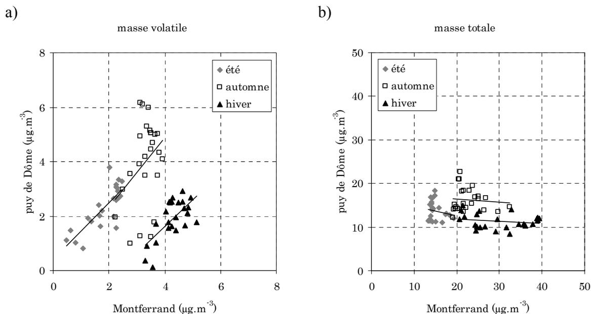
Figures III-20. Masse journalière mesurée au puy de Dôme en fonction de celle mesurée à Montferrand. (a) masse volatile et (b) masse totale.
