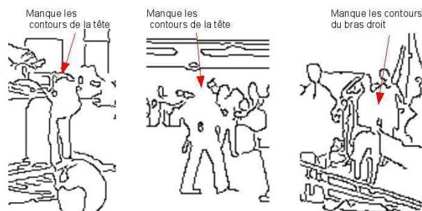
FIG. C.1 – Suite au filtrage de Canny est obtenue une carte des contours. La plupart d'entre eux ne sont cependant pas fermés ce qui pose dans notre cas problème.
