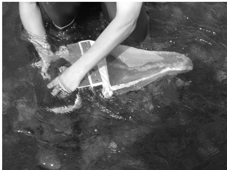
Figure 3 : Photographie de l'appareil de prélèvement : échantillonneur de type Suber.
