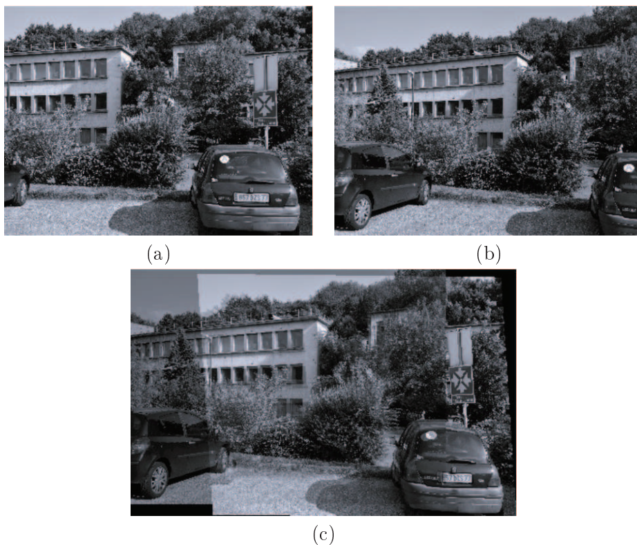
FIGURE 5.13 – (a) et (b) Deux images successives d'une séquence. (c) Résultat de l'alignement en supposant un modèle de transformation affine.
