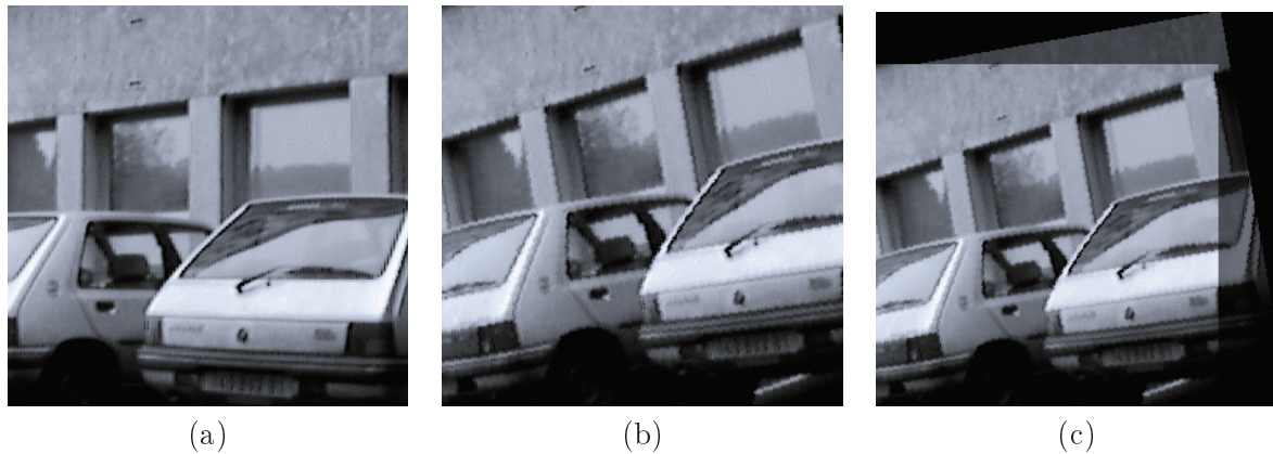
FIGURE 5.12 – (a) image 1. (b) image 2. (c) Raccord obtenu : la dynamique de l'image 1 a été réduite pour transparence. Après transformation, elle est superposée sur l'image 2. La transformation trouvée et effectuée est : dx = 5 , dy = 3 , teta = 9 , échelle = 1, 0096. Le recalage est satisfaisant pour les besoins de commande dans ce type d'applications.
