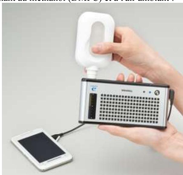
**Figure I-13: Système de recharge à  $\mu$ DMFC Dynario de Toshiba (2009) [AKw]**
