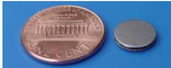
**Figure I-3: Sonde Thermo Life<sup>®</sup> comparée à une pièce d'un cent [TLw]**
