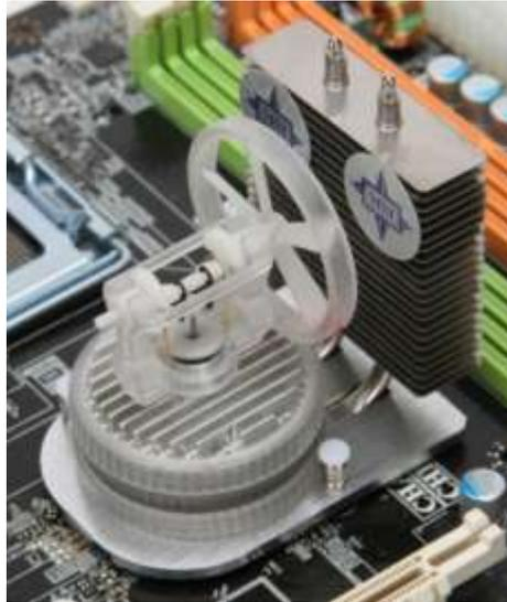
**Figure I-2: Système de micro génération thermo/mécanique à moteur Stirling
