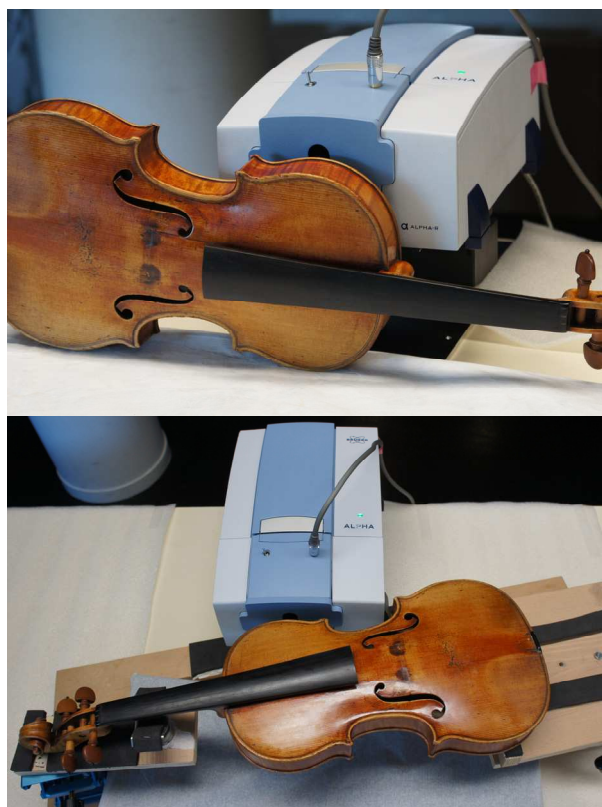
Fig. 5-10 : Photographie au cours des mesures en IR-RS à l'aide du spectromètre Alpha (Bruker) sur le violon « le Provigny » sur le dos (haut), et sur l'éclisse aigüe (bas) de l'instrument.
