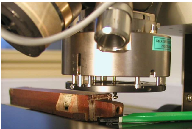
Fig. 5-8 : Photographie du tuyau d'orgue au cours de l'analyse de son vernis par micro-ATR. Les zones d'analyses choisies correspondent à des surépaisseurs de vernis comme des coulures.
